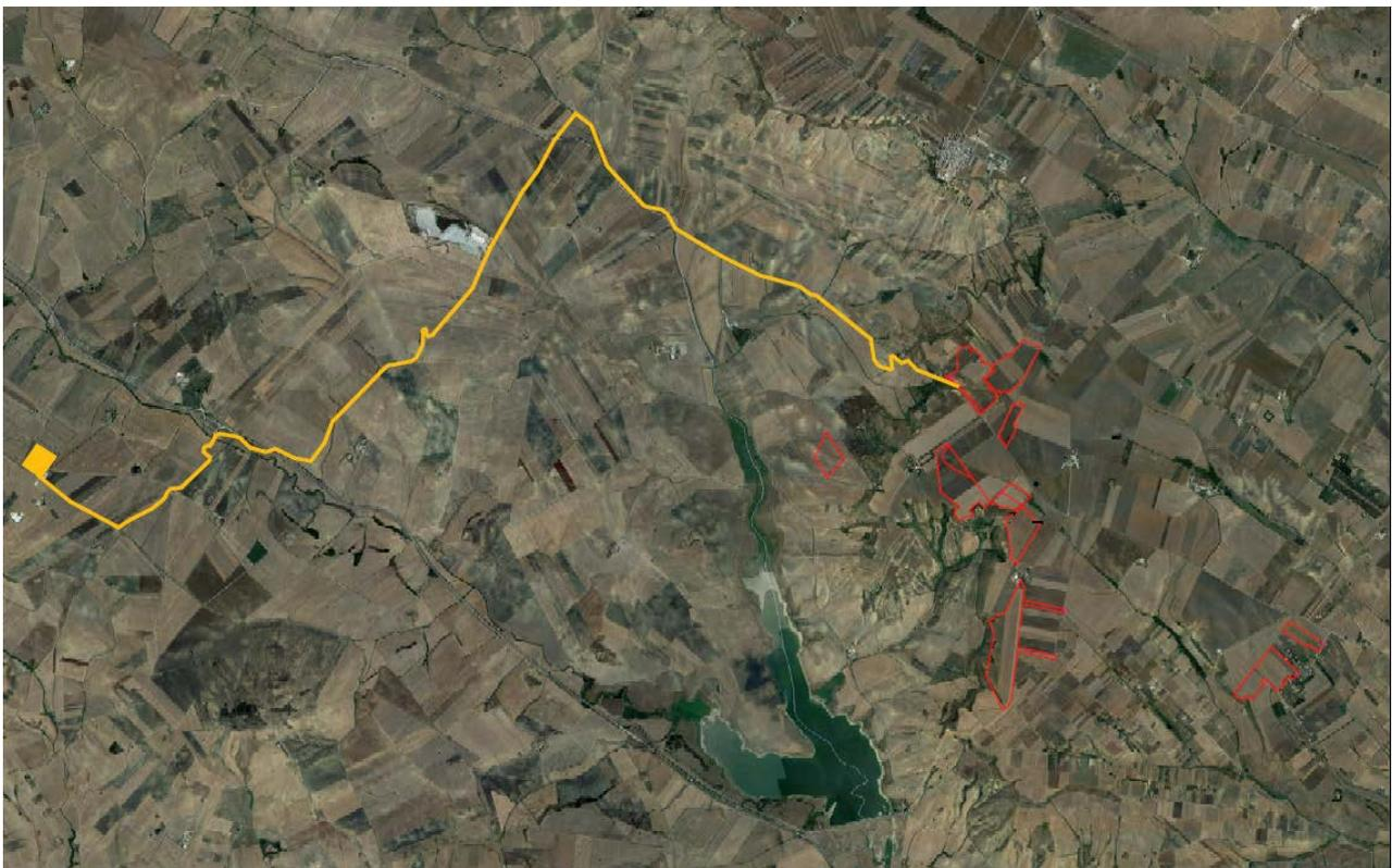
**Figura 3-10 - Parco agrivoltaico e connessione alla stazione 380/150 kV di Genzano**
