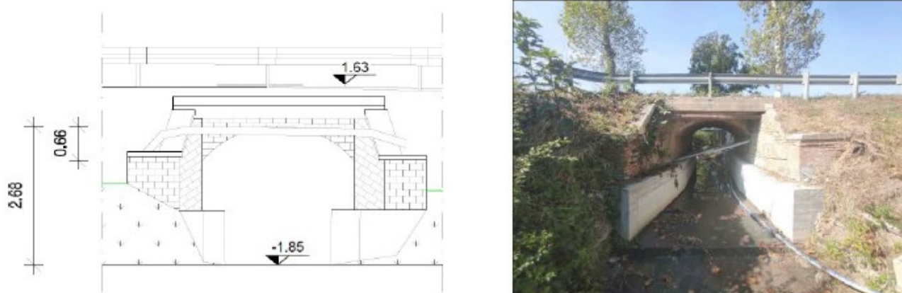
Fig. 4 –Dettaglio del manufatto esistente al km 48+050 della SS 14 (Fonte: Lista di Controllo)
