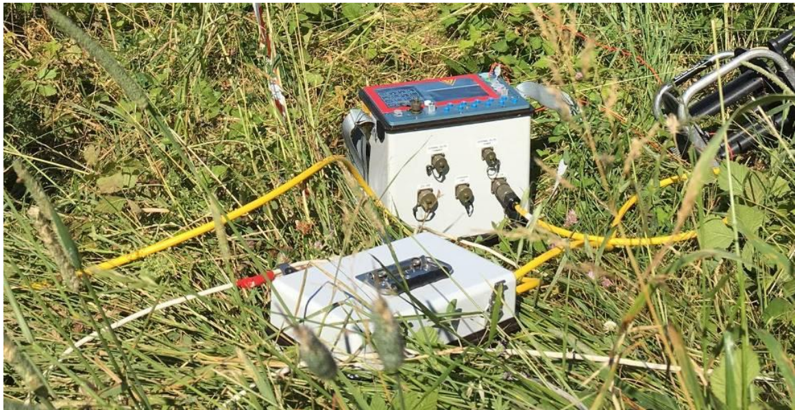
Figura 11 - Strumentazione di misura IRIS – Syscal PRO Switch 48
