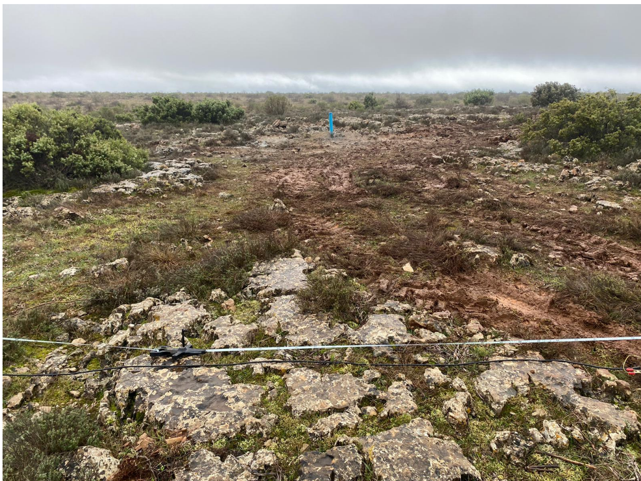
Foto 7 - Localizzazione del sondaggio NA-1 (tubo blu) rispetto alla linea di acquisizione dati ERT-2 (100 mi circa dall'inizio del profilo). In primo piano affioramento di dolomie.
