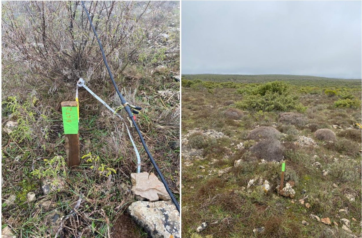
Foto 1 - Localizzazione degli estremi delle linee ERT sul campo mediante picchetti in legno.
