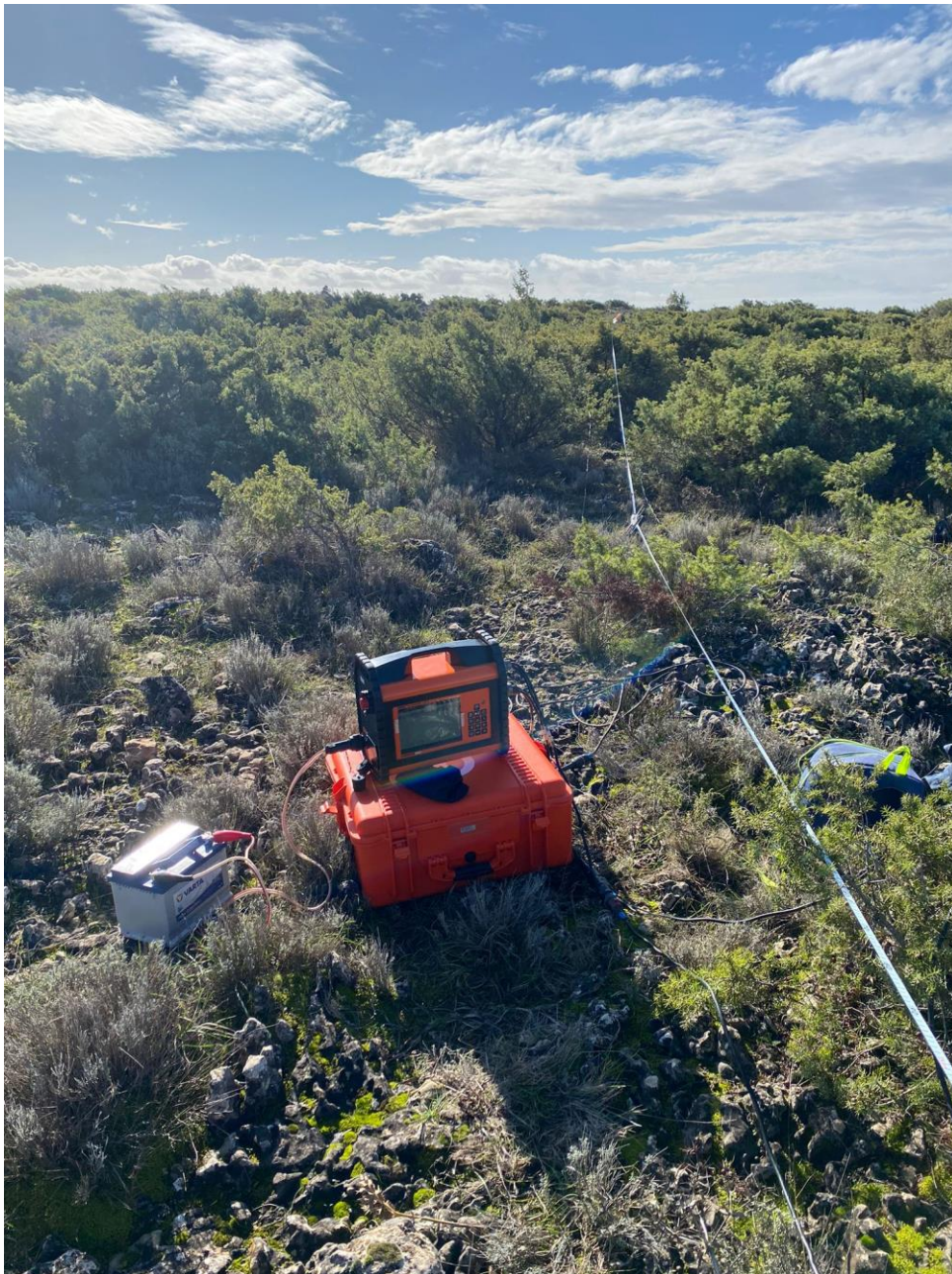
Foto 4 - Posizionamento del georesistivimetro nel punto centrale di ERT-1 durante le fasi di acquisizione dati.
