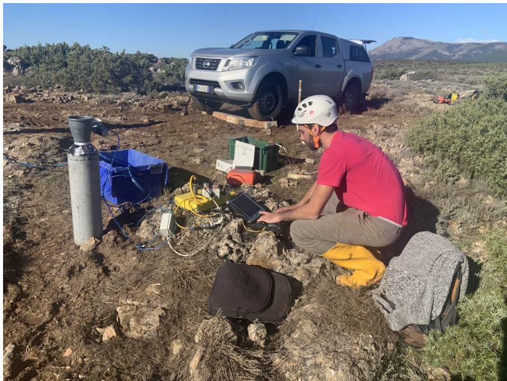
Figura 13 – Down-hole DH-S1 fase di acquisizione
