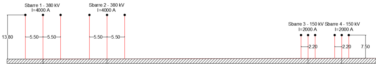
Figura 3 - Sezione di calcolo A-A riportata in planimetria.
