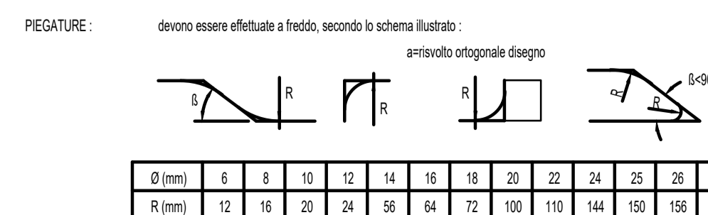
MODALITA' DI ESECUZIONE E POSA IN OPERA DELLE ARMATURE (salvo diverse esplicite disposizioni)
