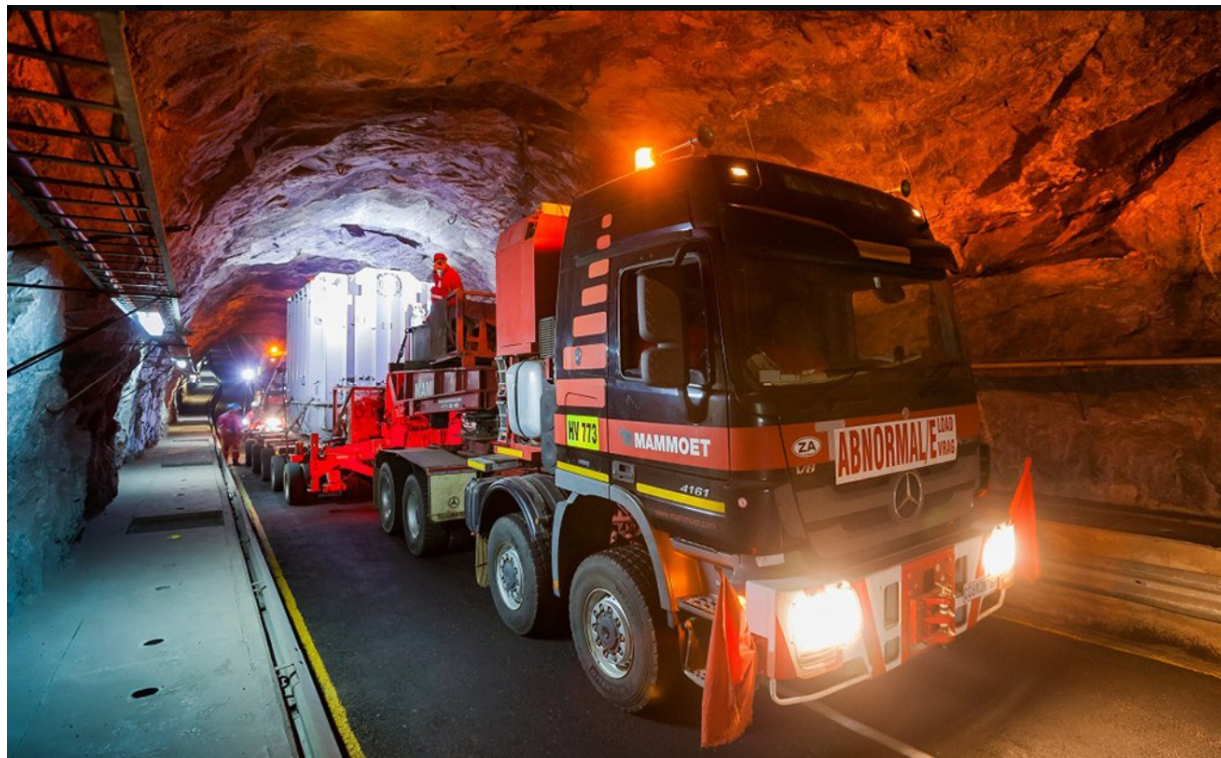
Figura 6 - esempio di trasformatore monofase analogo a quello in progetto - fase di trasporto
