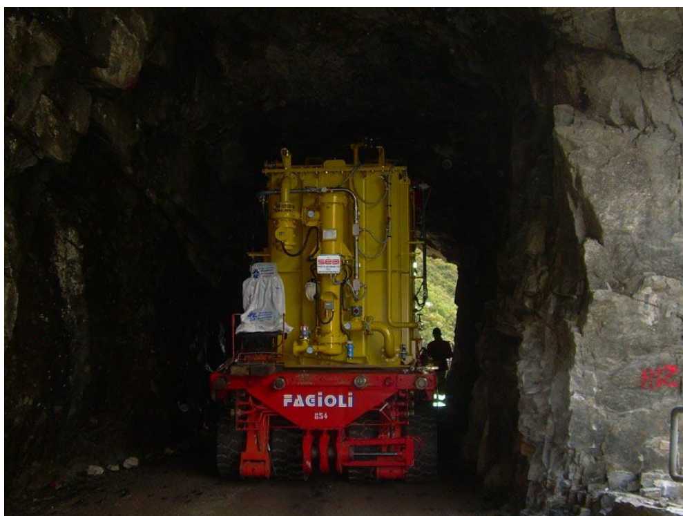
Figura 5- esempio di trasformatore monofase analogo a quello in progetto - fase di trasporto
