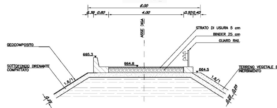
DETTAGLIO DEL MURO PARAONDE E CORDOLO
