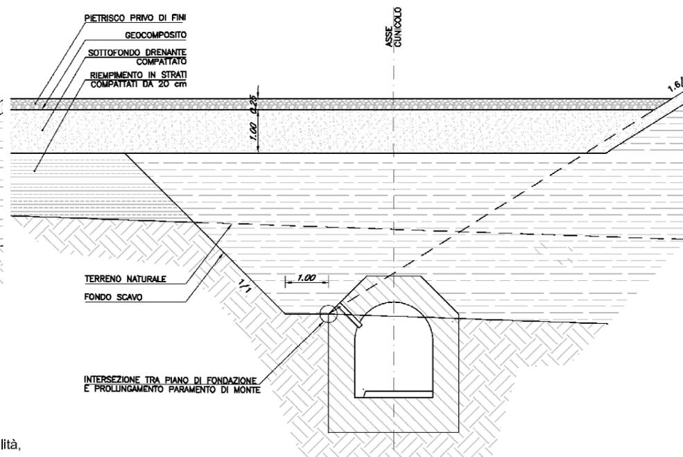
DETTAGLIO DELLA TUBAZIONE DI DRENAGGIO
