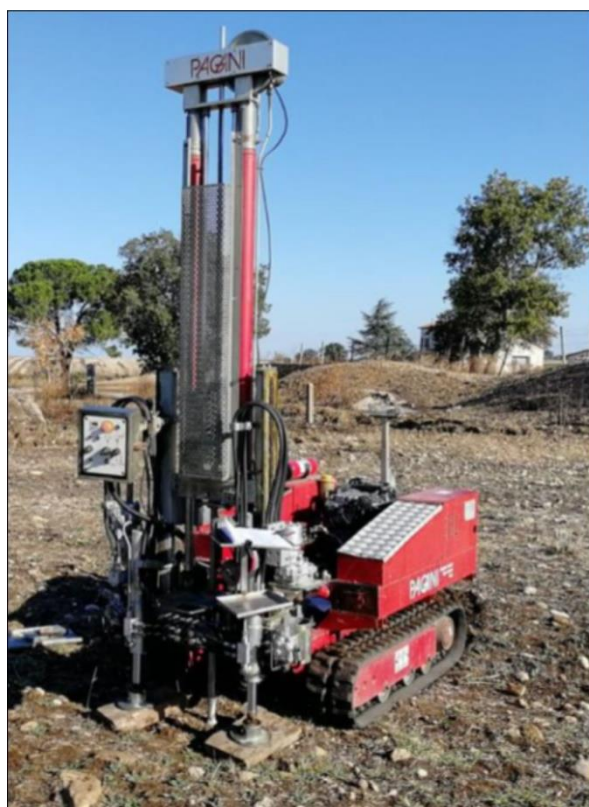
Fig.05: Prova penetrometrica eseguita nell'area prevista per l'installazione dei pannelli fotovoltaici e relativa elaborazione.
