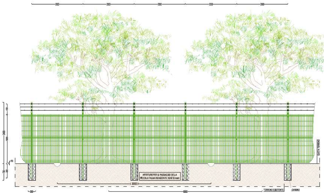
Figura 2-5: Prospetto recinzione con fascia di mitigazione
