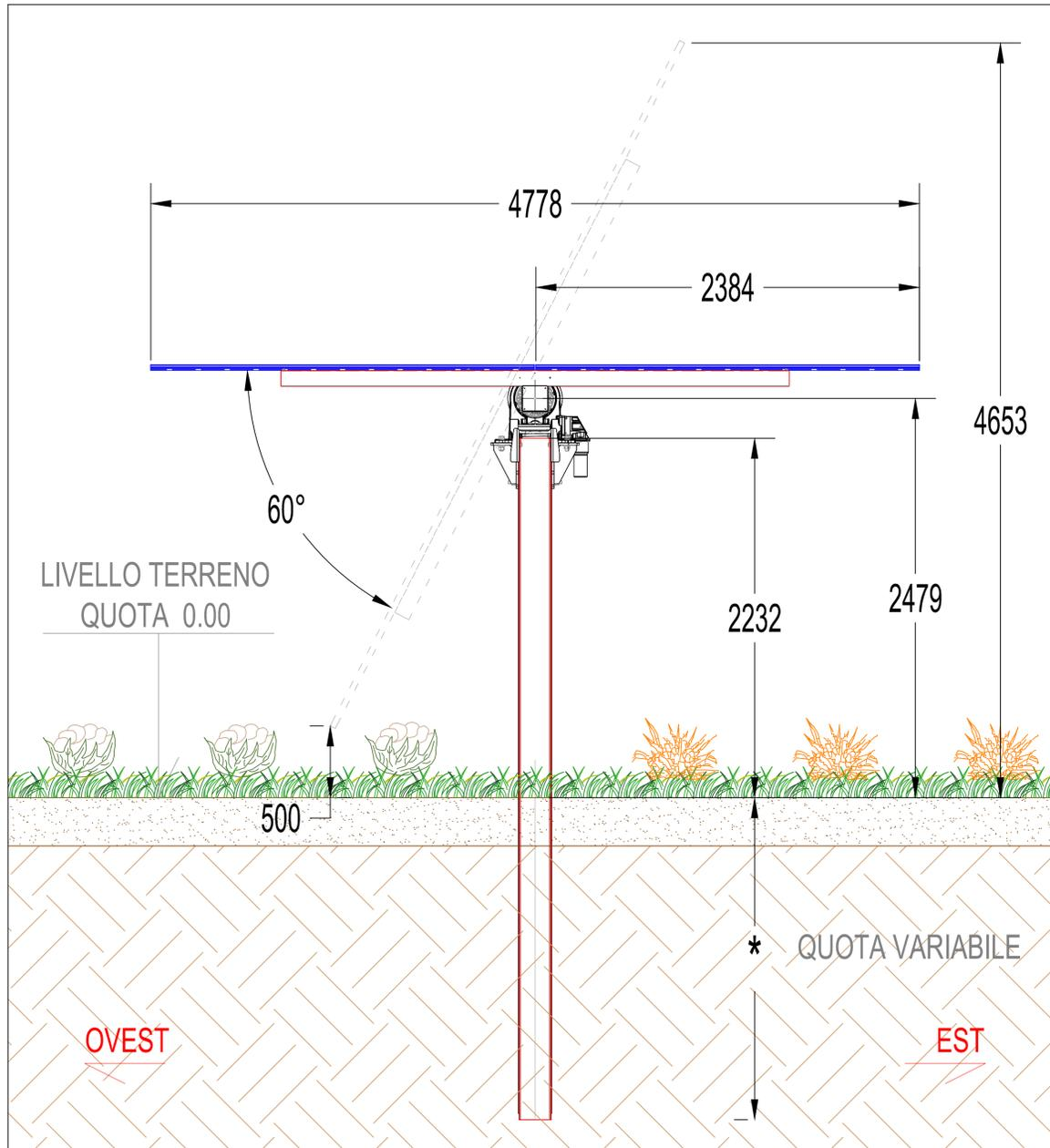
DETTAGLIO SEZIONE LONGITUDINALE STRUTTURA - SCALA 1:100
