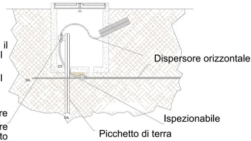
Il collegamento tra il dispersore orizzontale ed il dispersore verticale o tra il dispersore orizzontale ed il conduttore tipo N07VK dovrà essere effettuato tramite apposite morsettiere e dovrà essere adeguatamente ingrassato
