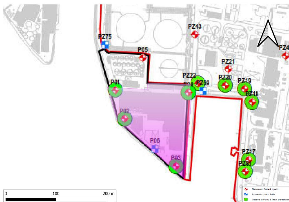
Figura 6.38: Ubicazione dei piezometri nell'intorno dell'area di intervento, quest'ultima in viola
