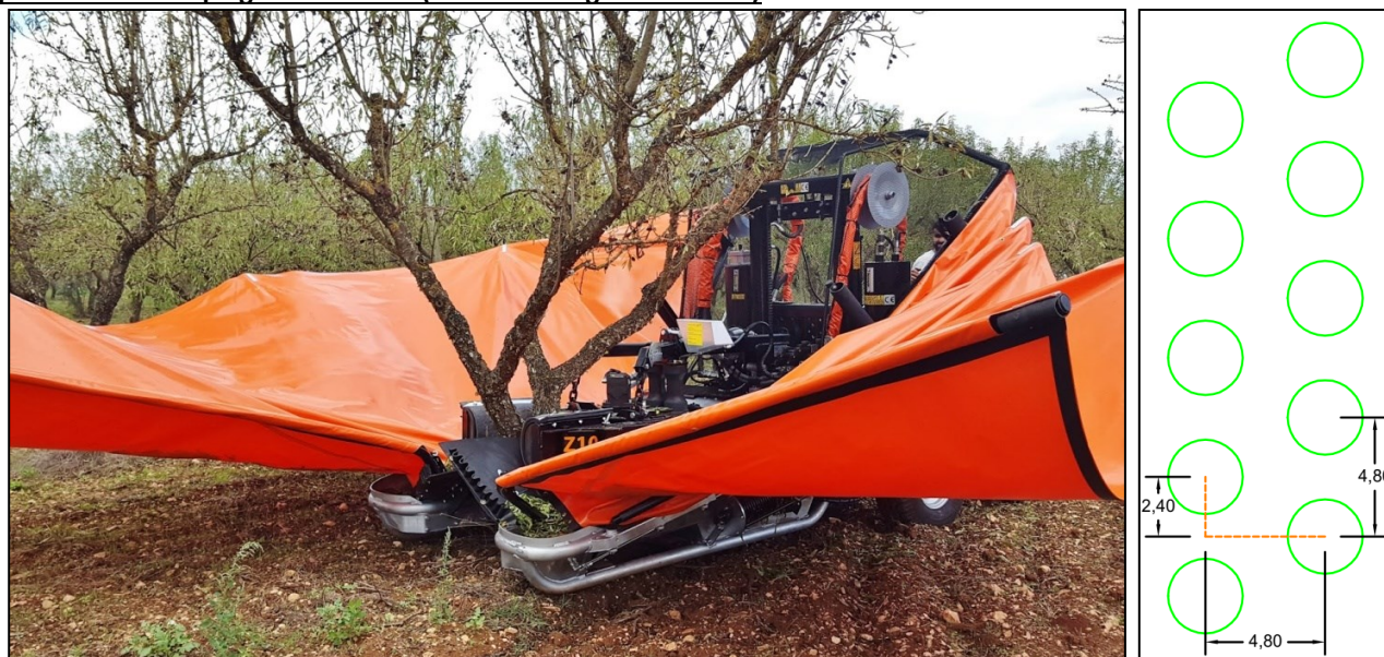
Figura 7.2: Macchina frontale per la raccolta delle mandorle su impianto intensivo e disposizione ideale degli alberi per il corretto impiego della stessa (Foto: Dott. Agr. Vito Vitelli)
