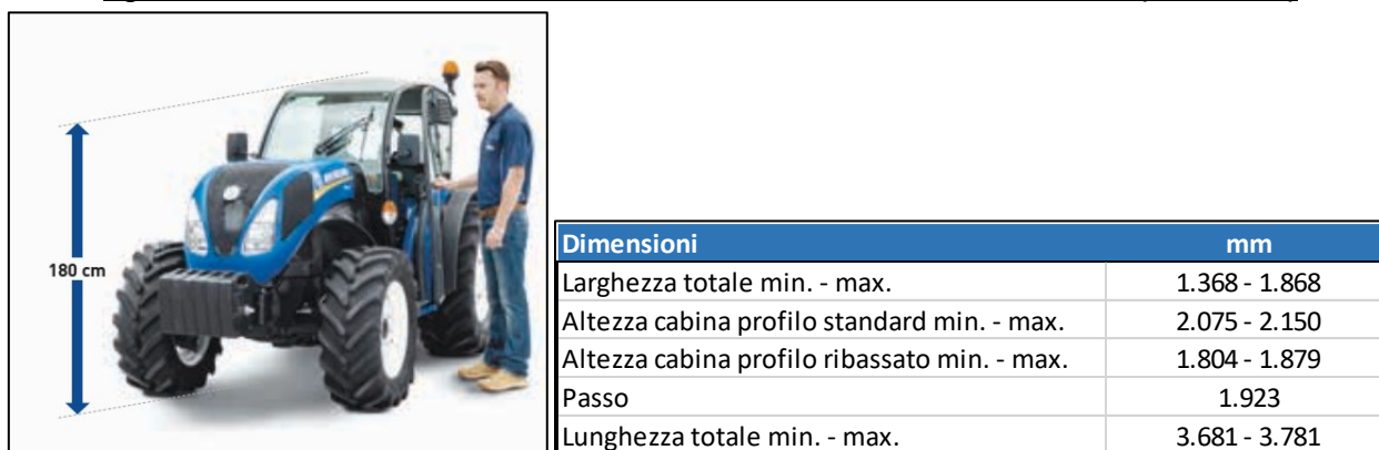
Figura 8.1: Dimensioni caratteristiche di un trattore da frutteto con cabina ribassata (Fonte: CNH)
