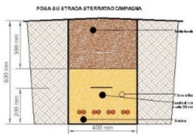
Figura 12: Particolare sezione tipo cavo interrato BT
