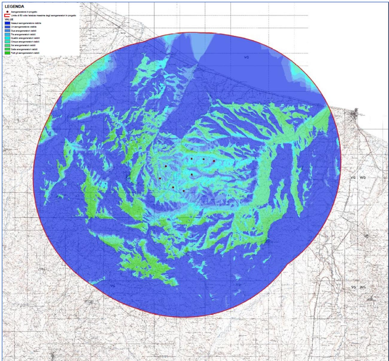
Figura 2 - Mappa dell'intervisibilità degli aerogeneratori - metodo 1
