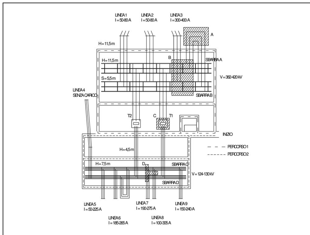
Fig. 1 – Pianta di una stazione 380/150 kV con indicazione delle tensioni e delle correnti durante la fasi di misurazioni di campo elettrico e magnetico.
