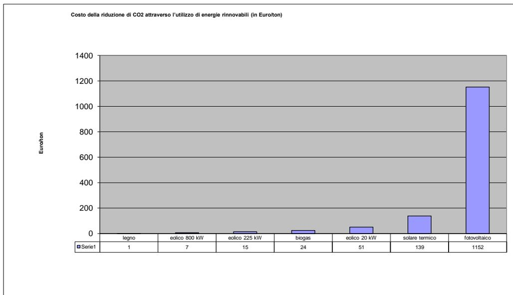
Costo per tonnellate di emissioni evitate di CO<sub>2</sub> per differenti tipi di tecnologie
