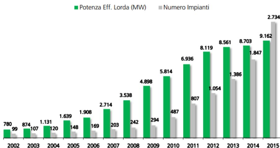
Dagli inizi degli anni 2000 al 2015 si è assistito ad un forte sviluppo dei parchi eolici in Italia. Alla fine del 2002 gli impianti installati erano 99, con una potenza pari a 780 MW; alla fine del 2015 il parco nazionale risulta composto da 2.734 impianti, con potenza pari a 9.162 MW. Nel 2015 la potenza eolica installata rappresenta il 17,8% di quella relativa all'intero parco impianti rinnovabile, con una variazione di circa 14 punti percentuali rispetto al 2002 (4%).
