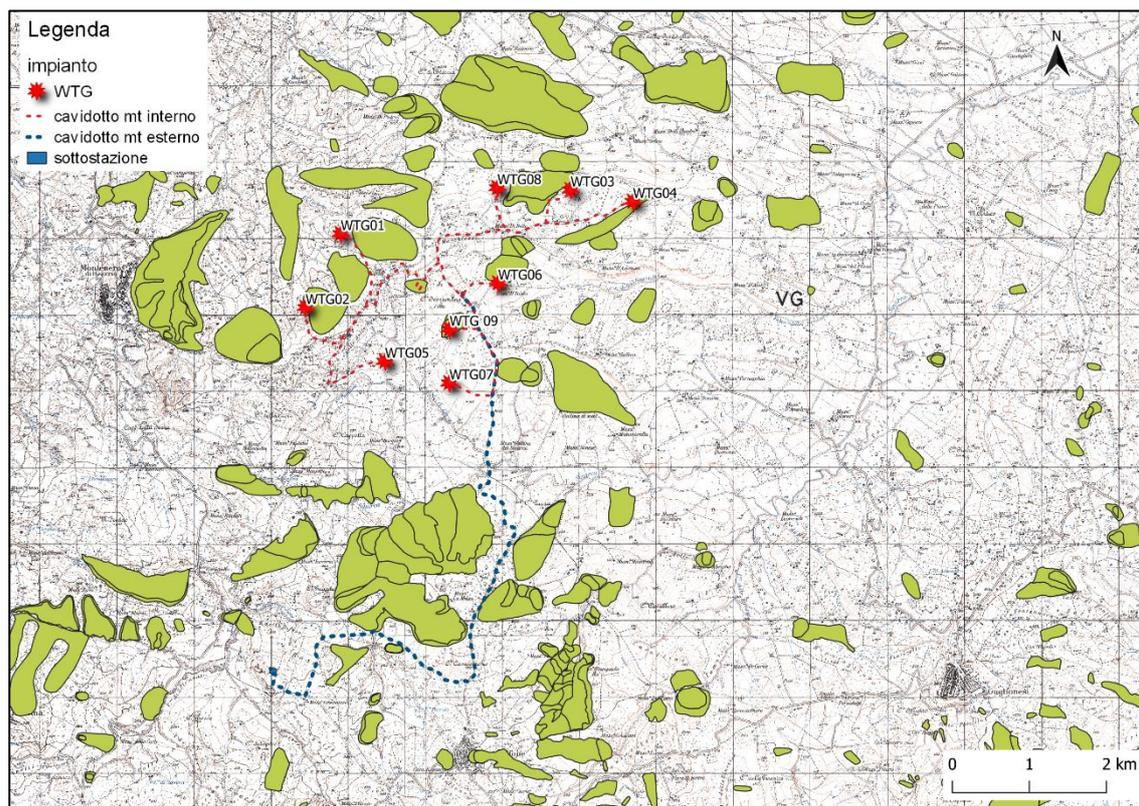
*Figura 25 - Ipotesi di layout a 9 aerogeneratori*
