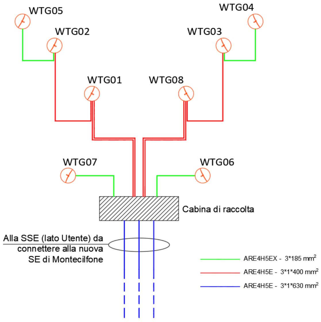
Figura 39- Schema di connessione elettrica dell'impianto eolico in progetto
