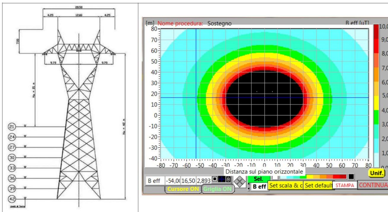
Figura 45 - Risultanze del calcolo delle DPA per un sostegno in singola terna a delta rovesciato
