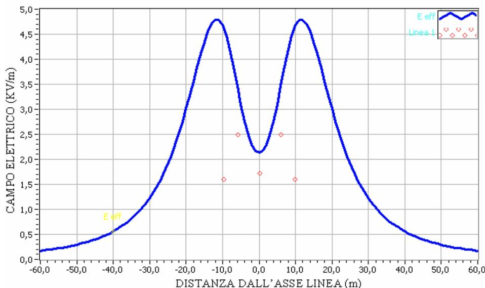
Figura 46 - Risultanze del calcolo di campo elettrico per un sostegno in singola terna a delta rovesciato
