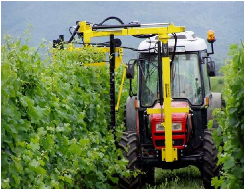
Illustrazione 3.14: L'immagine dimostrativa evidenzia una trattrice gommata convenzionale con braccio per le opere di "profilatura" delle siepi.
