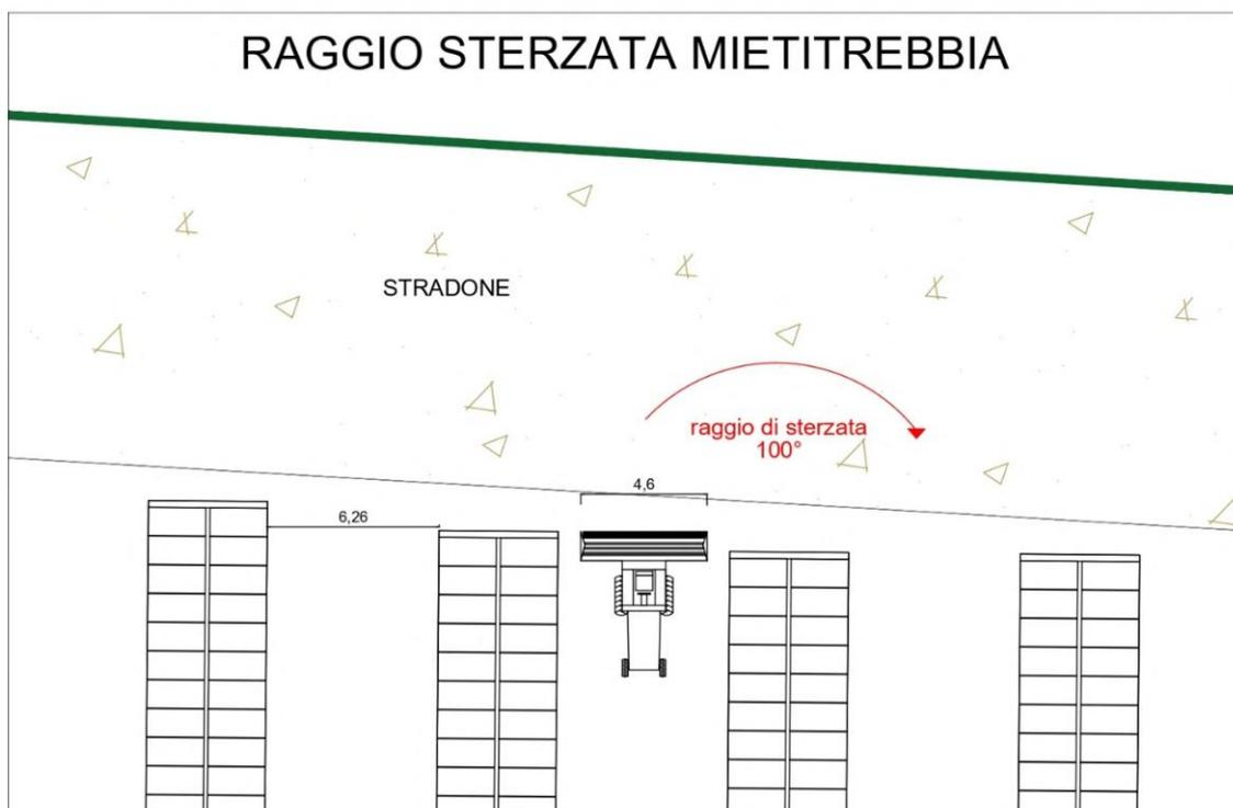
Illustrazione 2.16: Rappresentazione del raggio di sterzata del macchinario per la trebbiatura
