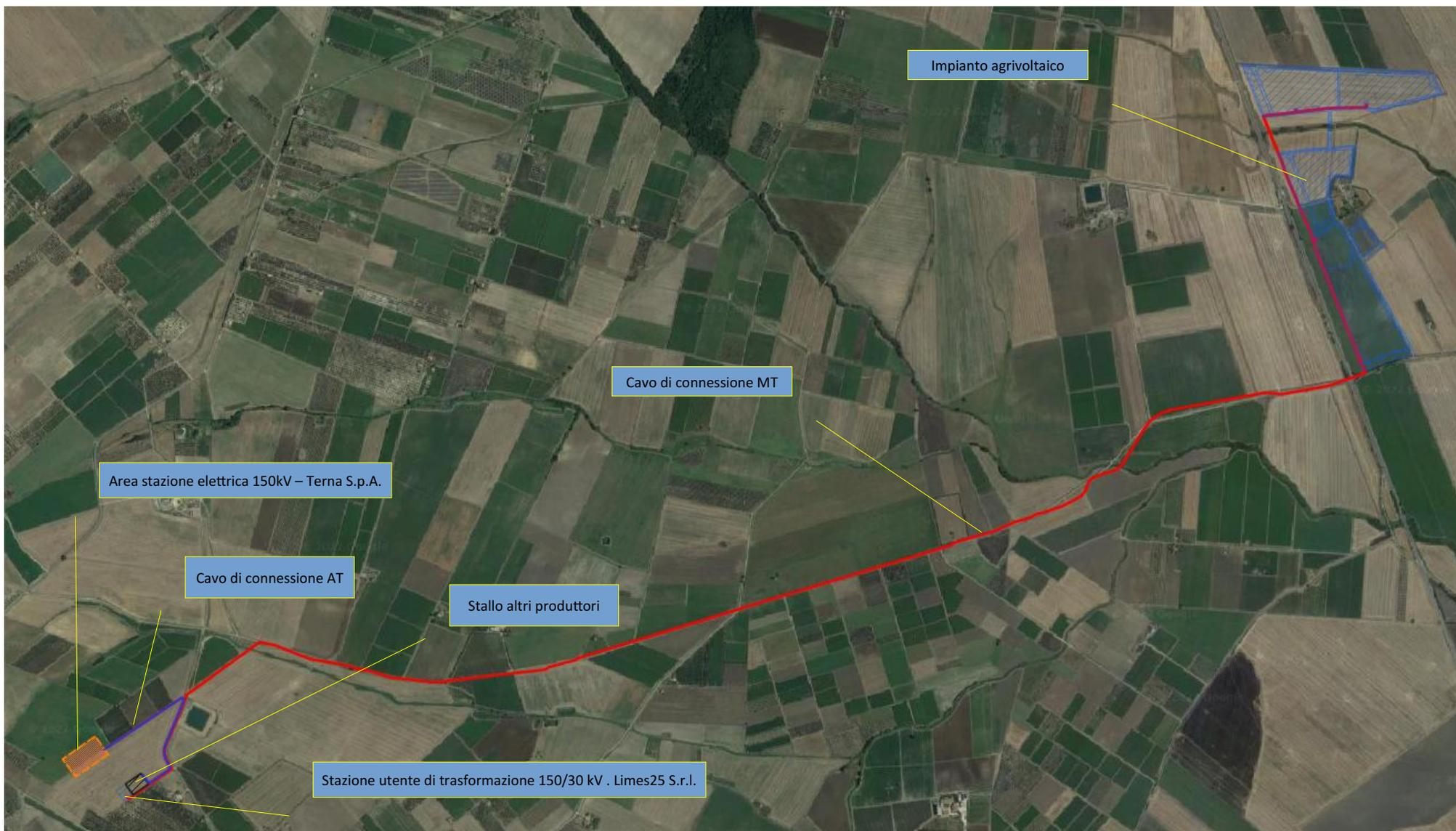
*Illustrazione 1.3: Vista d'insieme dell'impianto con collegamento in MT/AT (per una visualizzazione di dettaglio della mappa si veda elaborato B4HXL97\_4.1\_3\_inquadramento su ortofoto)*
