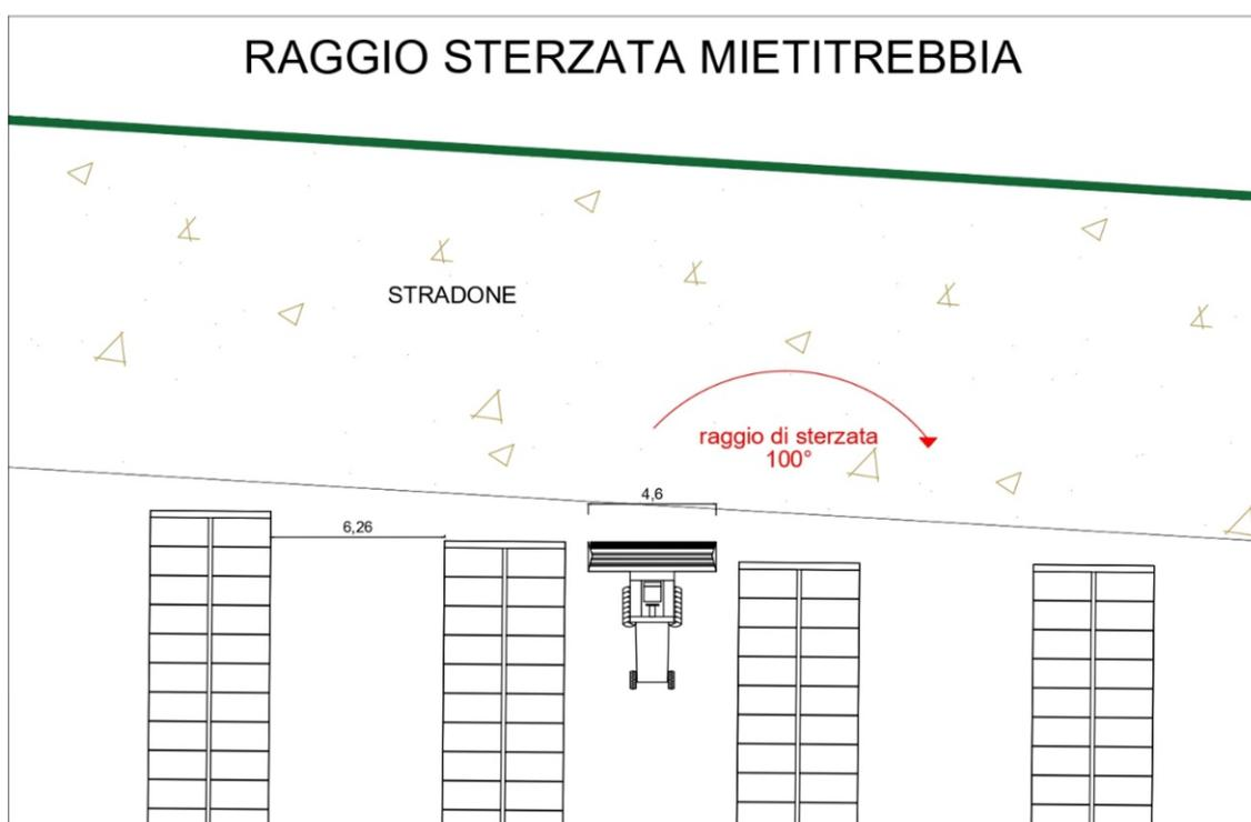
Illustrazione 1.25: Rappresentazione del raggio di sterzata del macchinario per la trebbiatura
