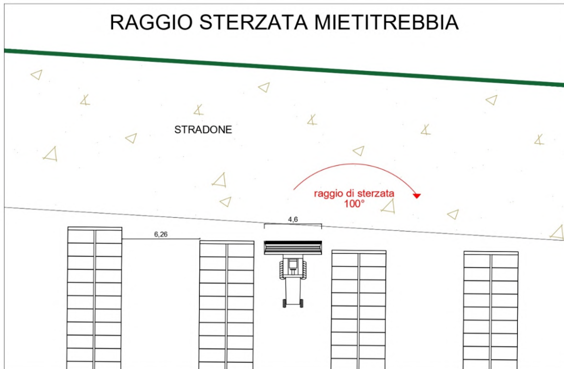
Illustrazione 2.13: Rappresentazione del raggio di sterzata del macchinario per la trebbiatura
