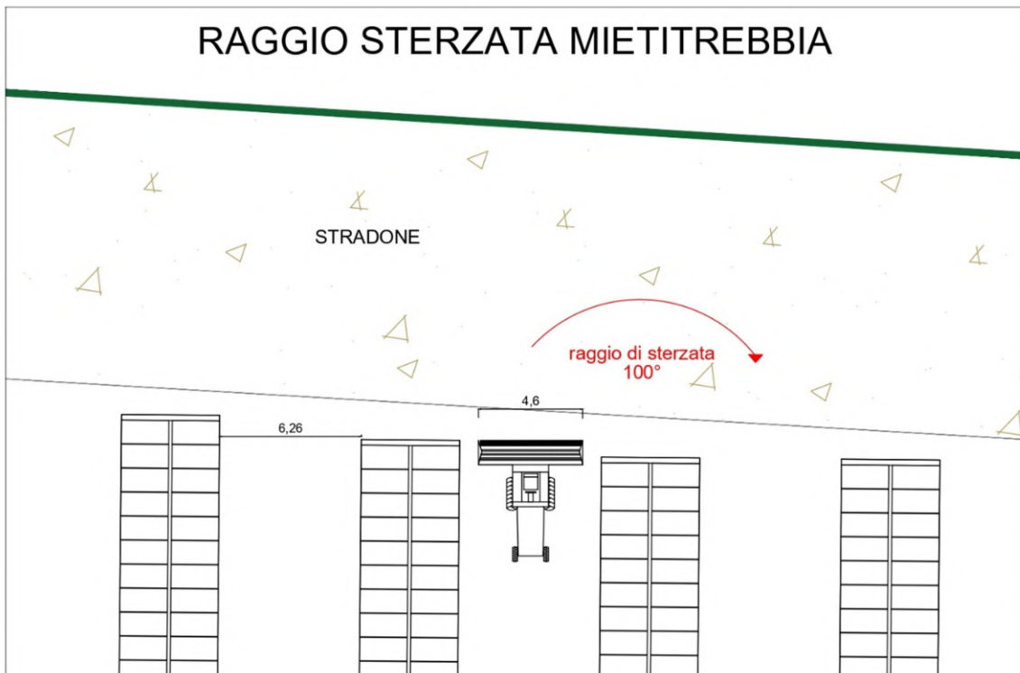
Figura 8-22 - Rappresentazione del raggio di sterzata del macchinario per la trebbiatura
