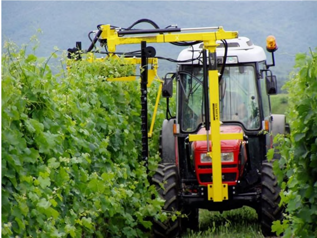
Figure 8-11. L'immagine evidenzia una trattoria gommata convenzionale con braccio per le opere di "profilatura" delle siepi.
