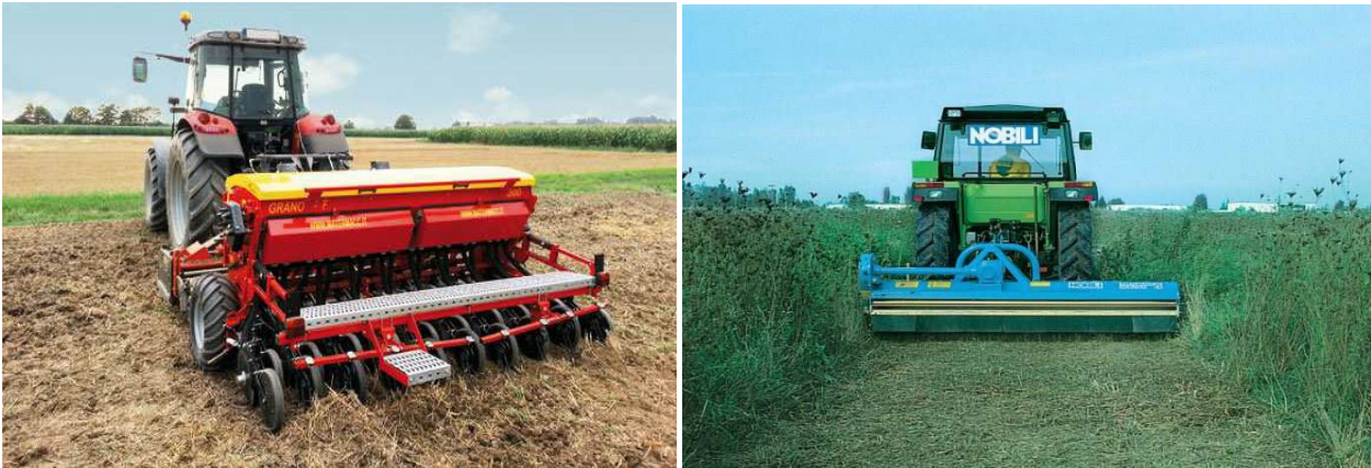
A sinistra: seminatrice di precisione (adattabile anche a semina su sodo); a destra: trinciasarmenti montata su trattore.
