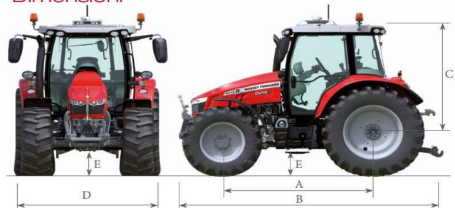
Dimensioni di una trattrice gommata ideale per la gestione dell'azienda (Fonte: Massey-Ferguson).
