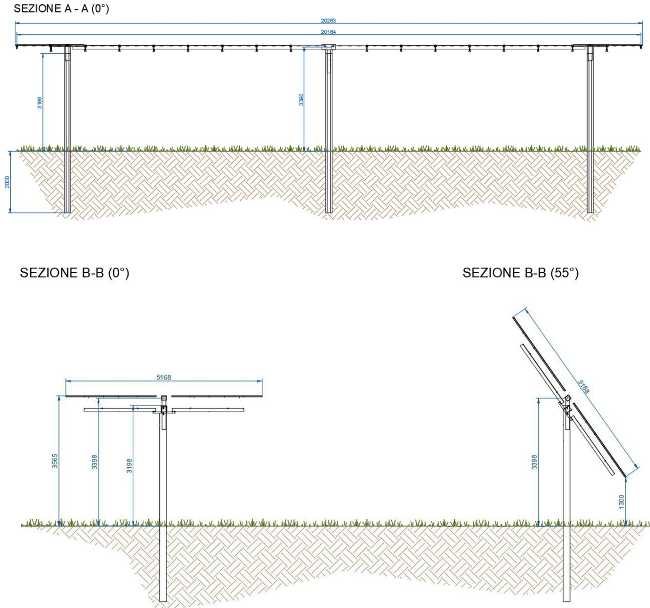
Fig.1 - Struttura di sostegno tipo.
