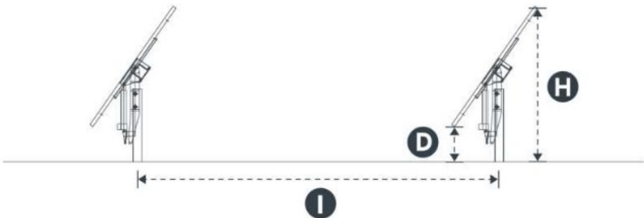
Definizioni delle dimensioni (D = 1,30 m, H = 5,55 m, l = variabile tra 9,20 m e 11,20 m).
