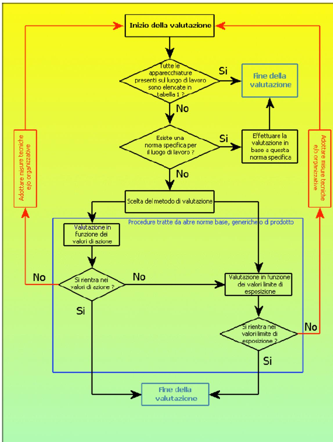
Figura 15: Diagramma di flusso del processo di valutazione del rischio elettromagnetico (CEI EN 50499)
