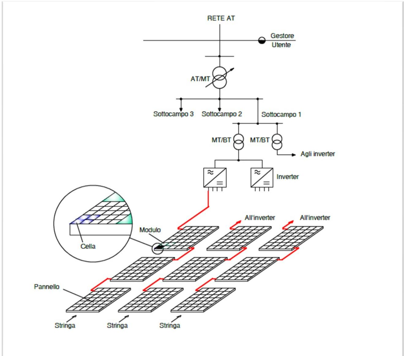
Figura 2: Schema di principio di una centrale fotovoltaica con indicazione delle stringhe fotovoltaiche
