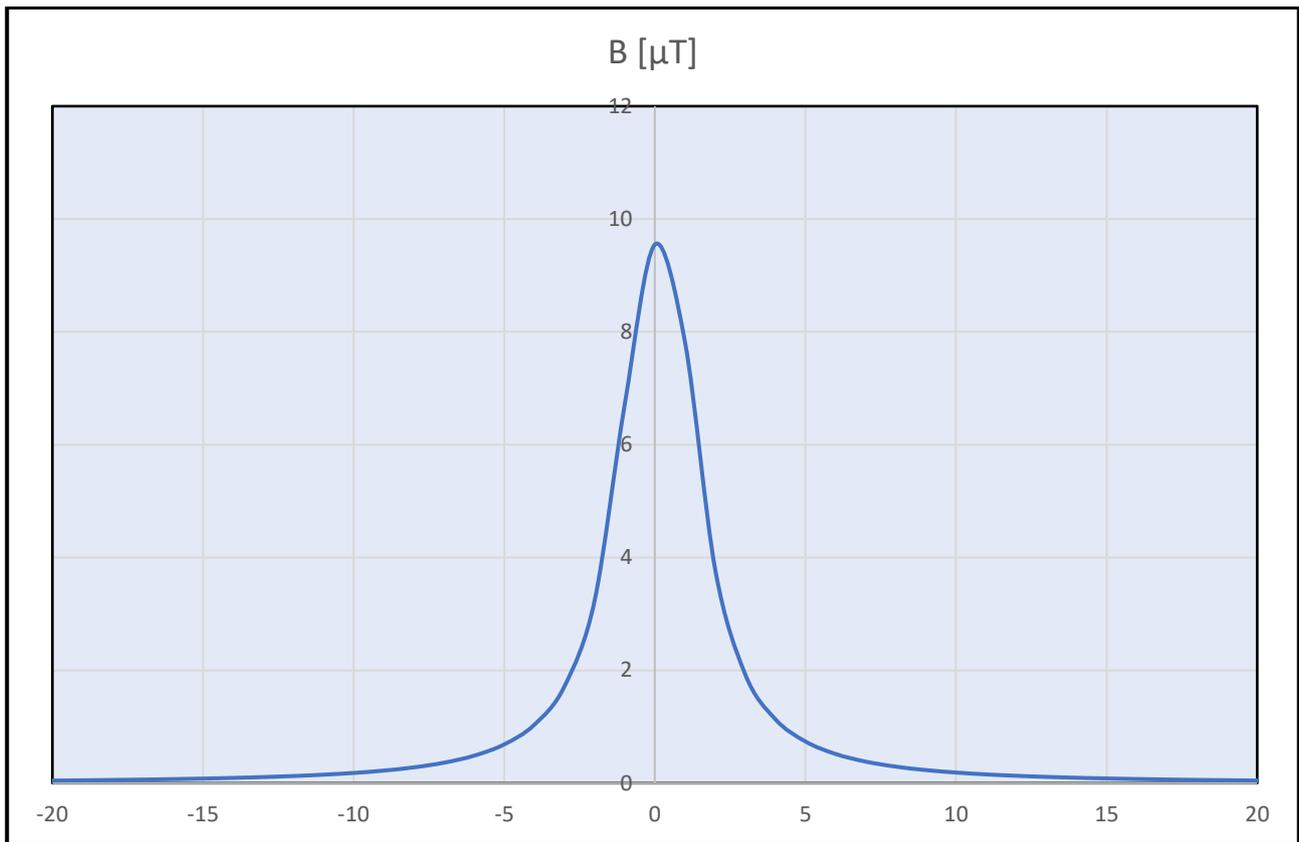
*Figura 7: Induzione magnetica generata dalle linee MT in corrispondenza dell'ultimo tratto della trincea di scavo, valutata ai sensi della Norma CEI 211-4 – Guida ai metodi di calcolo dei campi elettrici e magnetici generati da linee elettriche. Fasi disposte a trifoglio interrate ad una profondità non inferiore a 1,20 m e distanziate di 25 cm*
