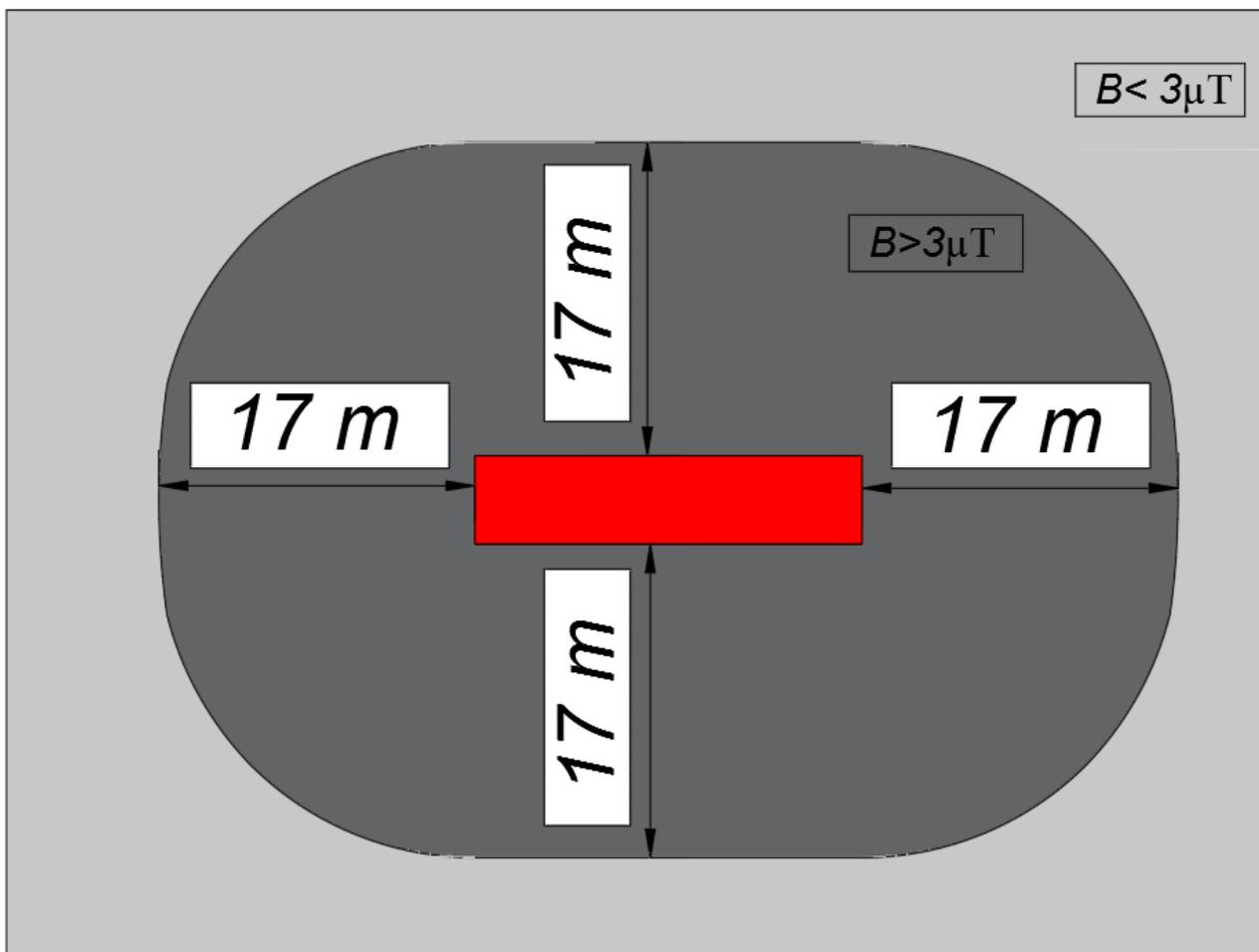
*Figura 4: Distanza di prima approssimazione cabina elettrica equipaggiata con n° 2 trasformatori da 4000 kVA*
