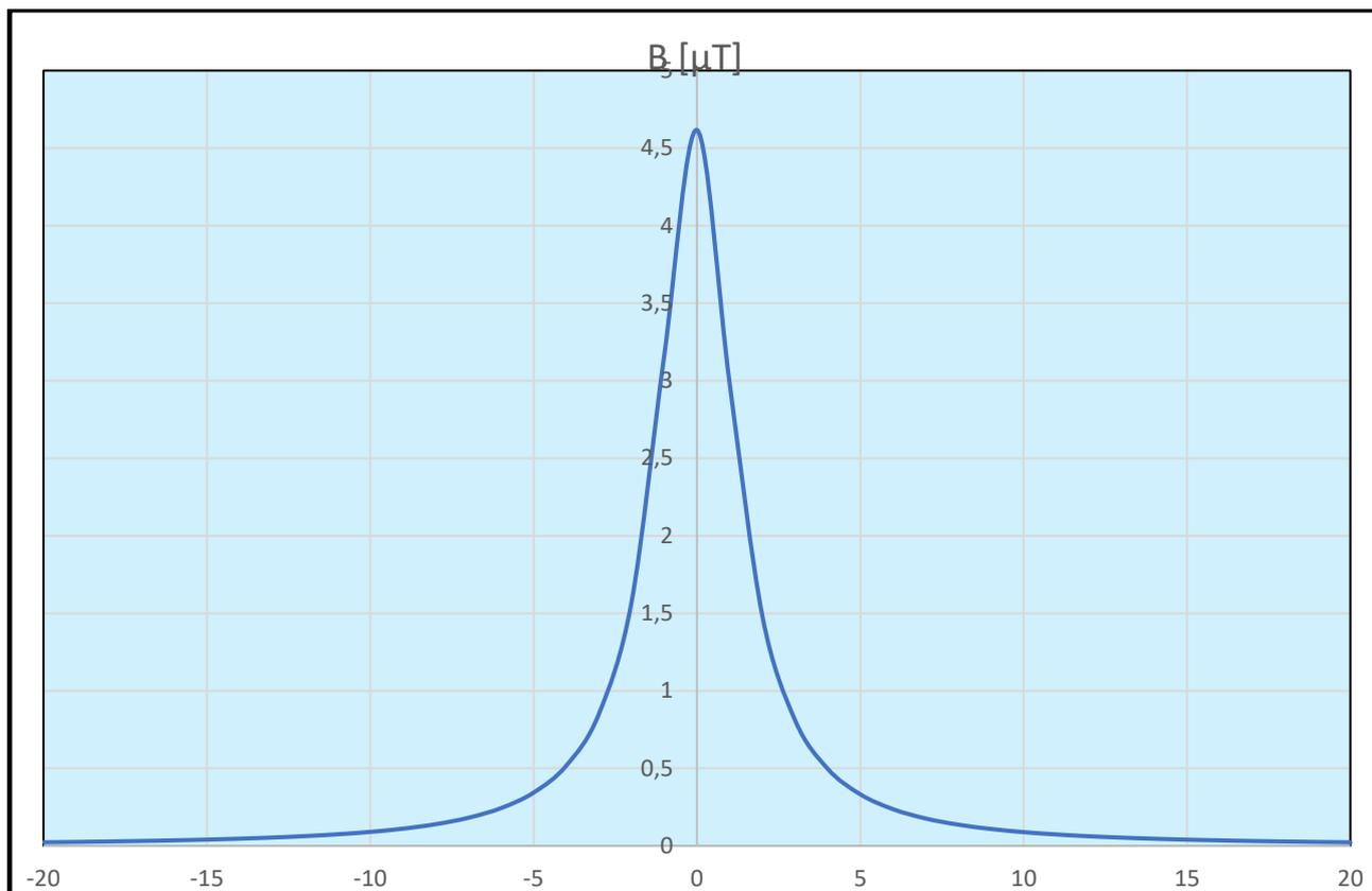
**Figura 8: Induzione magnetica generata durante l'esercizio dalla dorsale MT 30 kV costituita da 2 terne in parallelo da 400 mm<sup>2</sup> valutata ai sensi della Norma CEI 211-4 – Guida ai metodi di calcolo dei campi elettrici e magnetici generati da linee elettriche. Fasi disposte in piano, intensità di corrente  $I = 790\text{ A}$ , profondità di posa 1,40 m**
