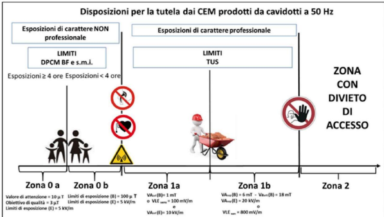
**Figura 14:** Misure di prevenzione e protezione per la tutela dai CEM prodotti da cavidotti a 50 Hz
