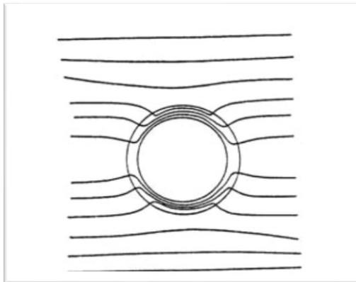
*Figura 18: andamento qualitativo della deformazione delle linee di forza di un campo magnetico uniforme per effetto di un nucleo in materiale ferromagnetico*
