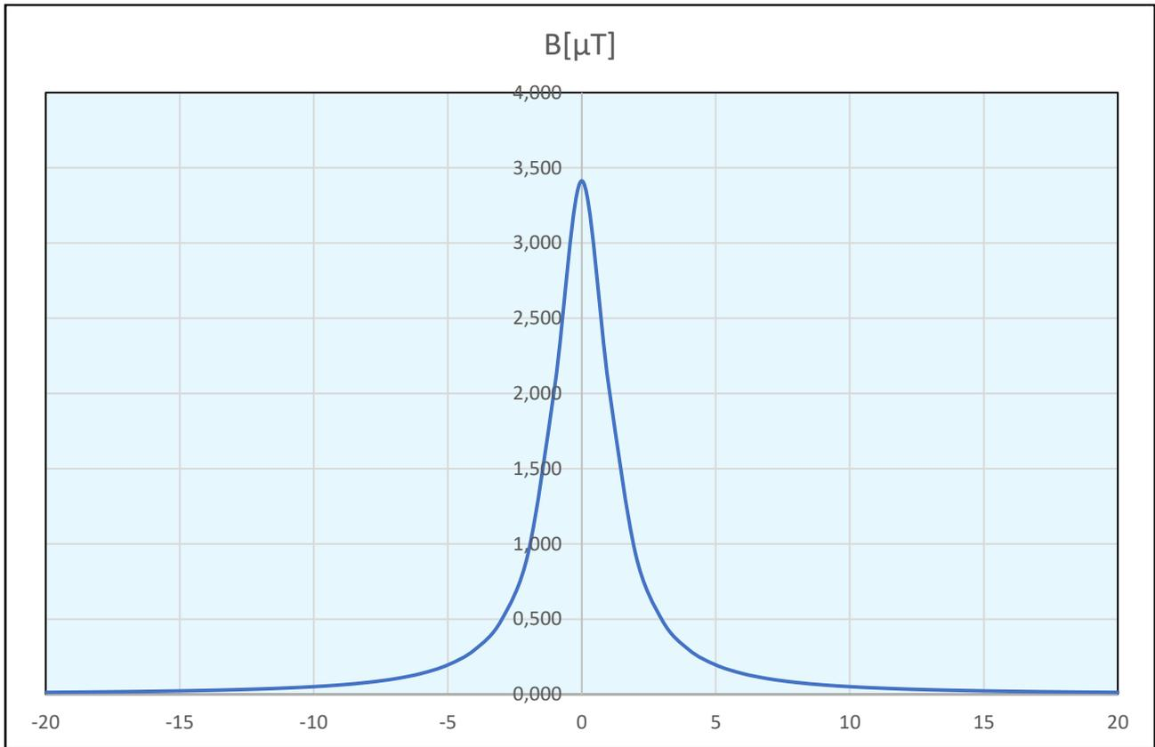
**Figura 6: Induzione magnetica generata durante l'esercizio dalla linea MT 30 kV da 400 mm<sup>2</sup> valutata ai sensi della Norma CEI 211-4 – Guida ai metodi di calcolo dei campi elettrici e magnetici generati da linee elettriche. Fasi disposte a trifoglio, intensità di corrente  $I = 385$  A, profondità di posa 1,20 m**
