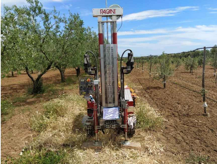
Prova penetrometrica dinamica continua DPSH 03
