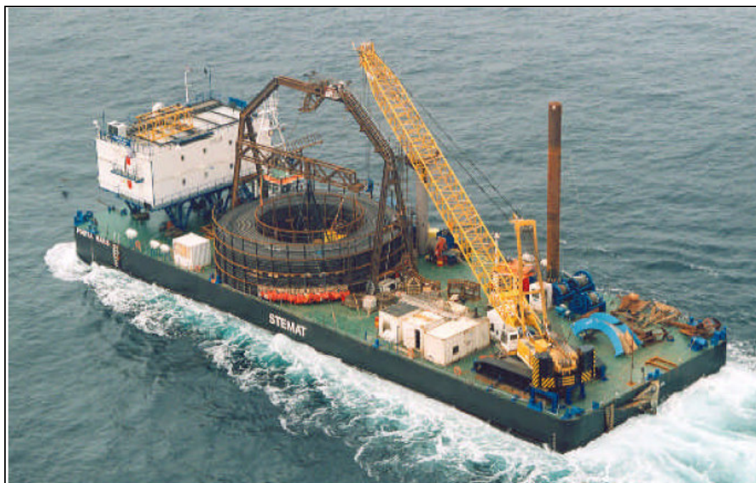
Nave posa cavo
