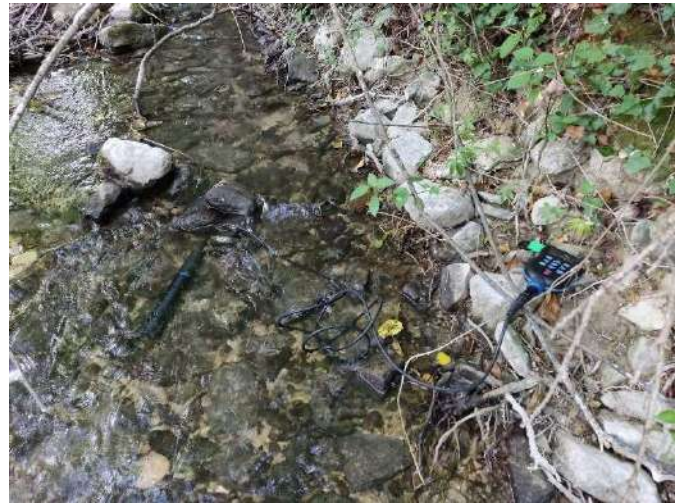
Torrente Assino (M) – Vista verso valle (1); Misura con sonda multiparametrica (2)
