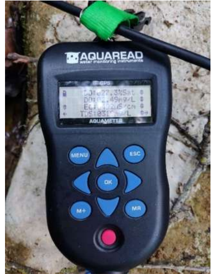
Torrente San Giorgio (M) – Vista verso monte (1); Fase di campionamento (2); Misura con sonda multiparametrica (3)
