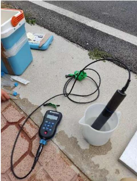
Fase di misurazione dei parametri chimico-fisici
