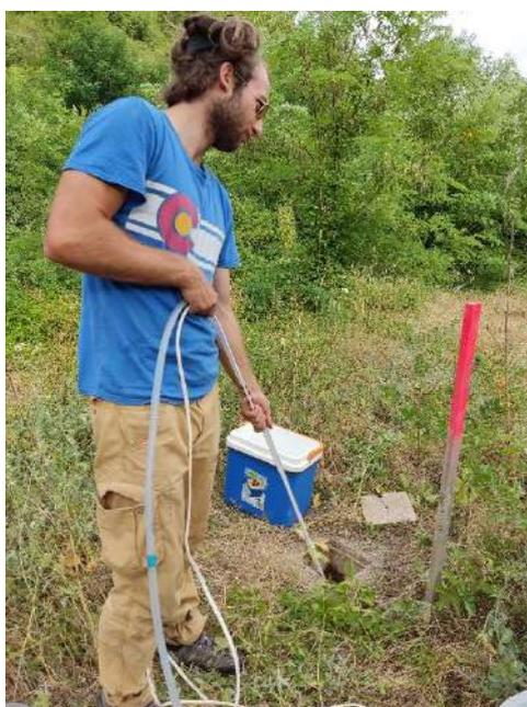
Immissione elettropompa all'interno del piezometro
