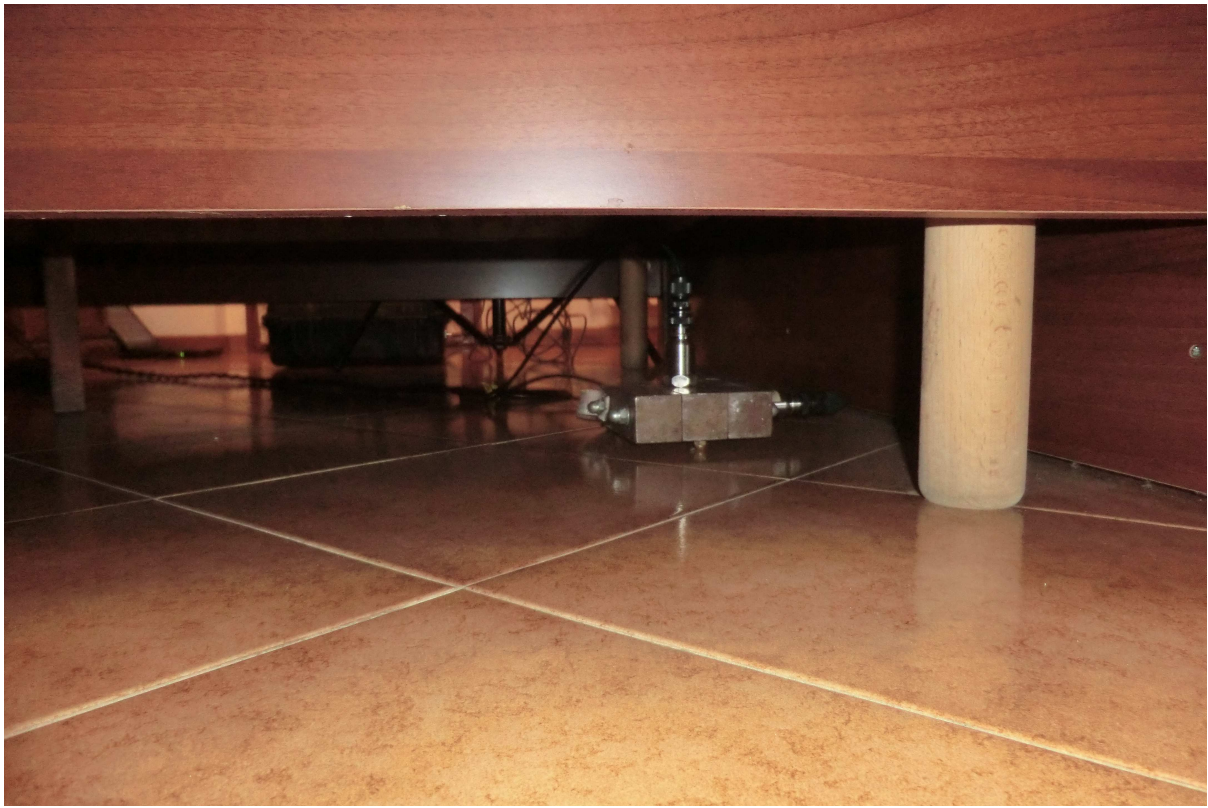
Posizionamento della terna accelerometrica
