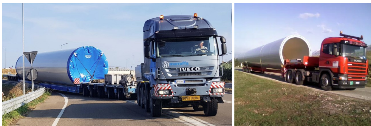
Figura 16 – Esempio di trasporto con convogli a pianale allungabile per conchi di torre
