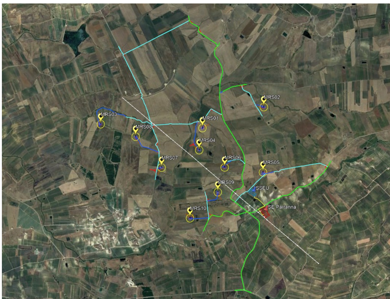
Figura 2 – Layout impianto eolico "Marsala-Allah"
