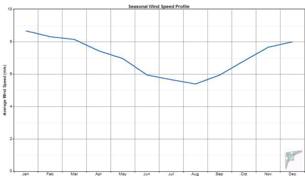
Figura 6 –Profilo velocità medie mensili di TDM Virtuale T03 a 122.5 m
