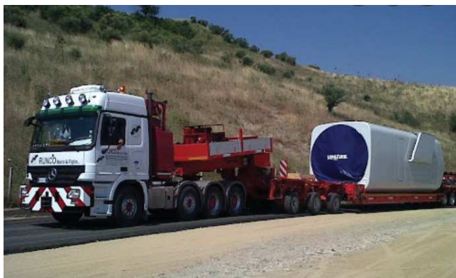
Figura 83 - Esempio di trasporto con convogli a pianale allungabile della navicella
