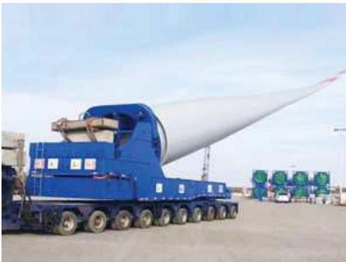
Figura 76 - Esempio di trasporto con Blade Lifter Trailer
