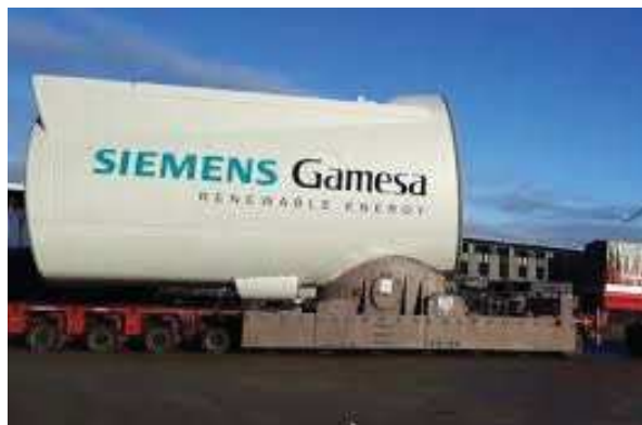
Figura 83 - Esempio di trasporto con convogli a pianale allungabile della navicella
