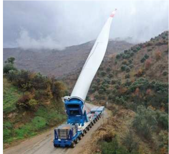
Figura 76 - Esempio di trasporto con Blade Lifter Trailer
