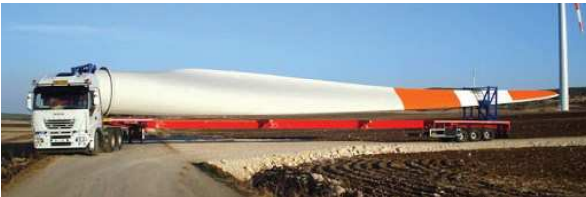
Figure 88 - Soluzione tipo del trasporto delle pale e pista di nuova realizzazione tipo per l'accesso alla turbina
