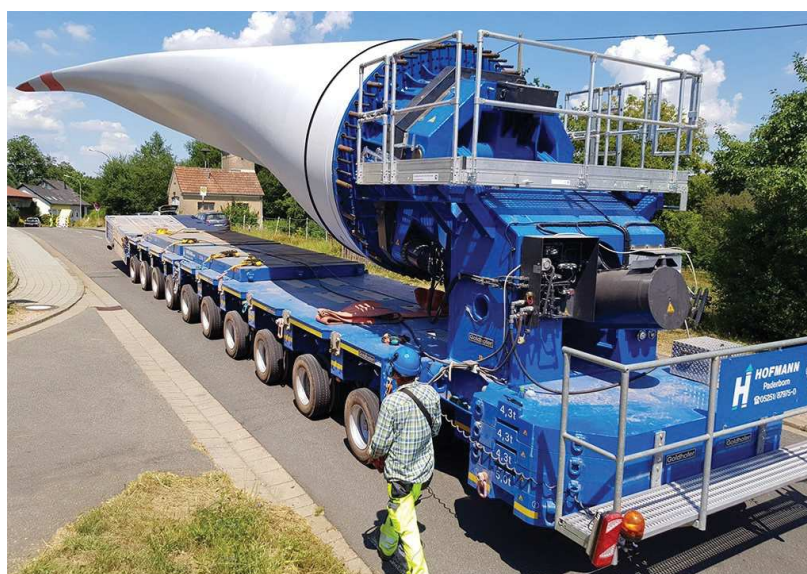
Figura 81 - Sistemi di trasporto pale: Blade Lifter
