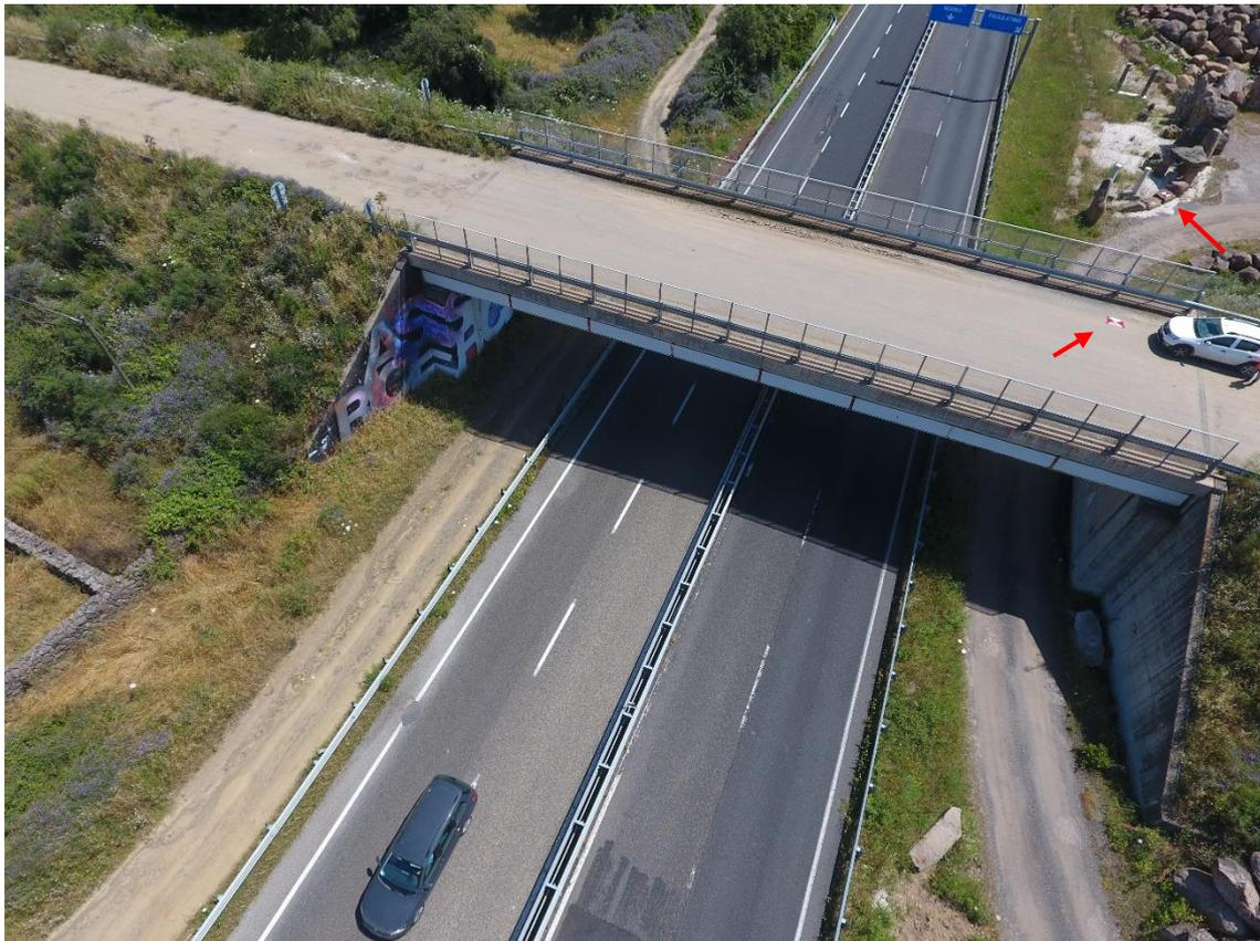
Figura 10 - esempio di immagine ad alta definizione ripresa per volo circolare di integrazione del rilievo sul viadotto al km 119 Paulilatino WBS V01. Si notino i due target posti sul cavalcavia e più in basso, a nord, lungo il confine della sede stradale con l'attività industriale di lavorazione della pietra.
