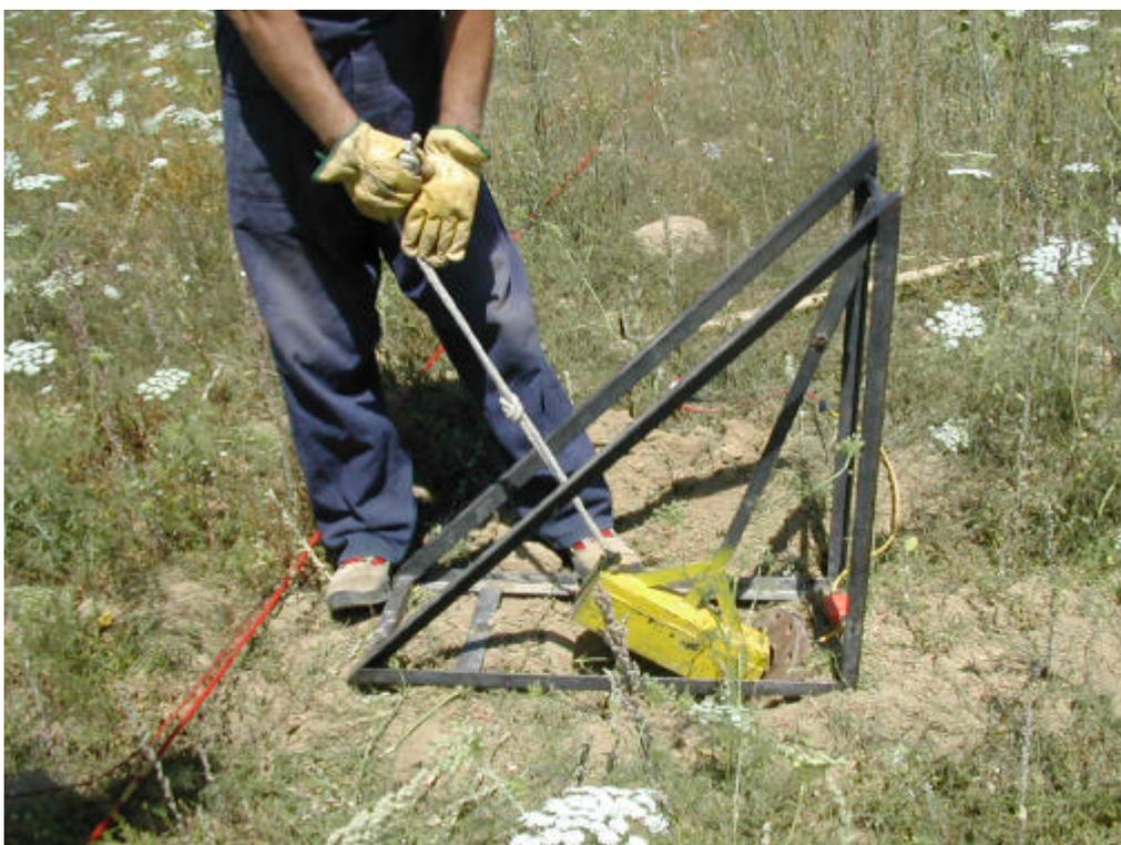
Le registrazioni relative alle onde SH sono state effettuate dopo la sommatoria, con polarità invertita del segnale, di impulsi generati ai due lati opposti della fossetta realizzata per collocare la piastra metallica nel terreno.
