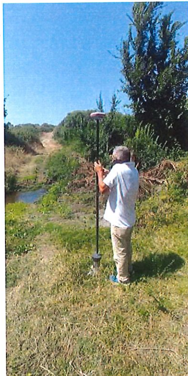
Fig. 3 – Posizionamento del sondaggio mediante stazione GPS
