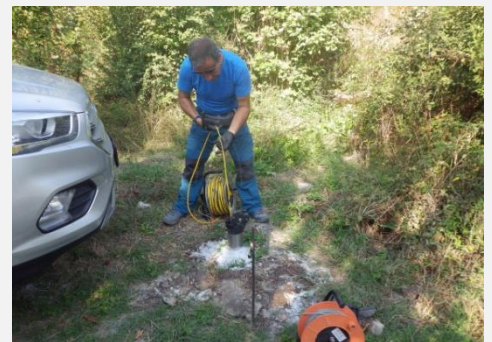
Foto 1 Esecuzione prova down-hole S1-DH
