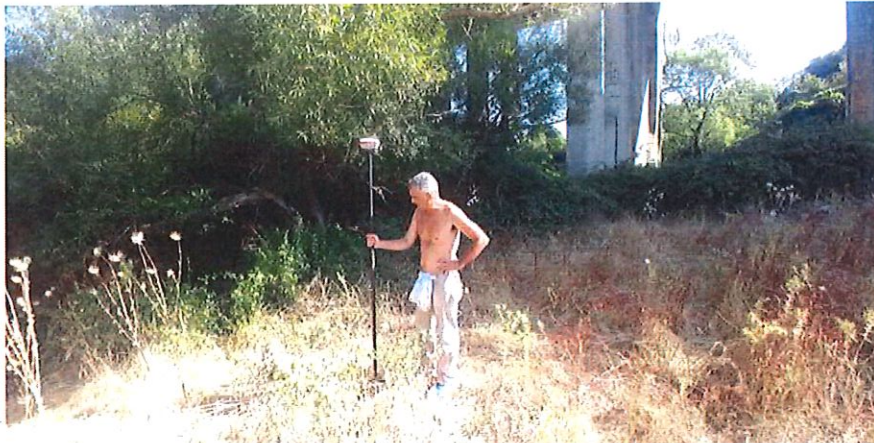
Fig. 3 – Posizionamento del sondaggio mediante stazione GPS
