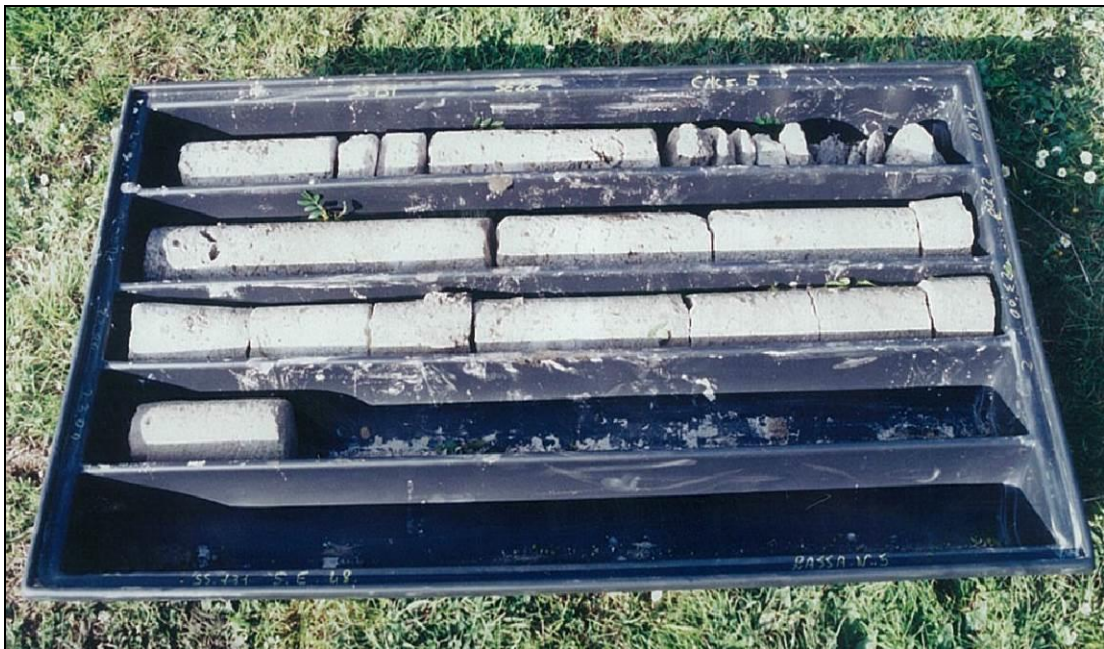
Foto 1 – Biocalcarene appartenente alla Formazione di Tadasuni, incontrata lungo il sondaggio SE48 (S.P.G. s.r.l. – 1997) in corrispondenza del Km. 112+500 della S.S.131, da 20 a 23,2 m di profondità da p.c.
