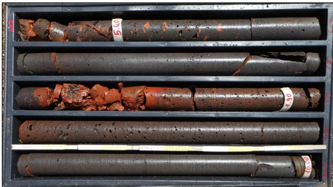
Foto 5 – Basalti della Campeda-Planargia appartenenti alla Subunità di Dualchi, incontrati nel sondaggio S23 (Sondedile s.r.l. – 2015) in corrispondenza degli accessi al Km 127+000, vicino allo Svincolo di Norbello.
