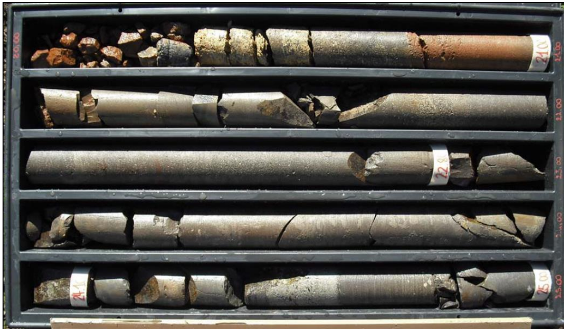
Foto 2 – Depositi piroclastici e ignimbrici appartenente all'Unità di Macomer, incontrati lungo il sondaggio S26 (Sondedile s.r.l. – 2015) nelle vicinanze del nuovo svincolo di Mulargia-Macomer al Km 148+500.
