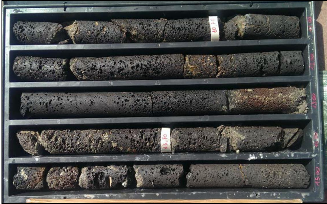
Foto 4 – Basalti della Campeda-Planargia appartenenti alla Subunità di Campeda, incontrati nel sondaggio S5 (Sonedile s.r.l. – 2015) in corrispondenza del ponte in progetto sul Riu Temu.
