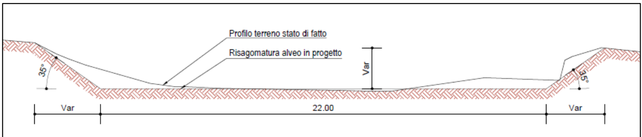
Figura 87 - Sezione tipologica sistemazione alveo in progetto per il tratto a valle della SS131
