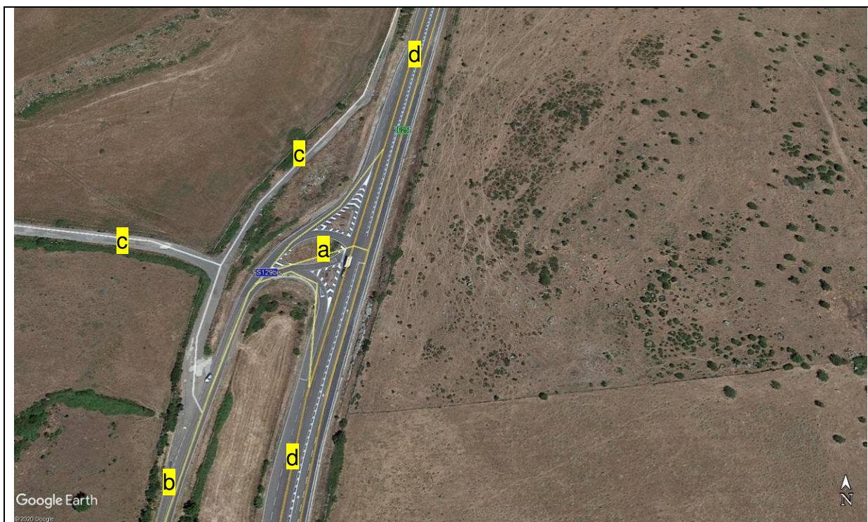
Foto 18 - Panoramica dello svincolo Macomer Nord dove si evidenziano i seguenti elementi: a= area di svincolo; b= asse della SS129 bis; c= tracciati della viabilità comunale secondaria; d= asse della SS131
