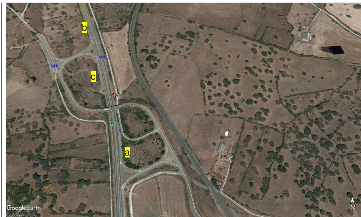
Foto 26 - Panoramica dell'area di svincolo. Si evidenziano i seguenti elementi: a= corsia di accelerazione carreggiata nord; b= corsia di decelerazione carreggiata sud uscita per Norbello; c= corsia di accelerazione ingresso carreggiata sud da Norbello.
