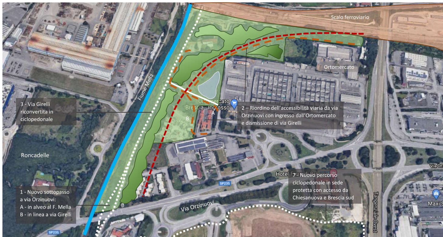
TAVOLA F – PROPOSTA ALTERNATIVA DI RIORDINO DELL’ACCESSIBILITÀ VIARIA DA VIA ORZINUOVI – La nuova viabilità di accesso da via Orzinuovi (SL01) viene traslata a sud del ramo ferroviario eliminando il sottovia (N01). Viene realizzato un nuovo accesso dall’Ortomercato dismettendo contestualmente quello da via Girelli che viene riconvertita in ciclopedonale.
