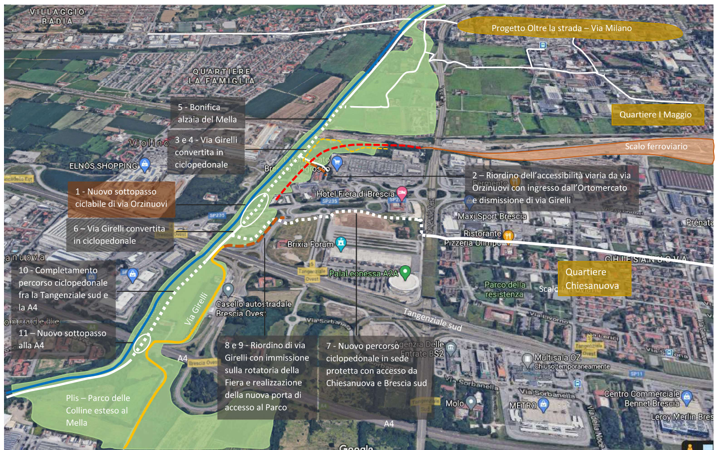
TAVOLA C – PROPOSTA DI RIASSETTO CICLOPEDONALE E VIARIO: SCHEMA AREA VASTA – Completamento del percorso ciclopedonale del Mella tra la ferrovia Mi-Ve e l'autostrada A4, nuova connessione con Chiesanuova ed i quartieri sud della Città e ripristino dell'accessibilità dai quartieri di Porta Milano e Primo Maggio
