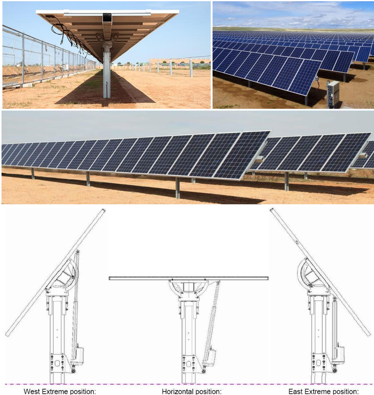
Figura 13 - Particolare di un inseguitore monoassiale est-ovest
