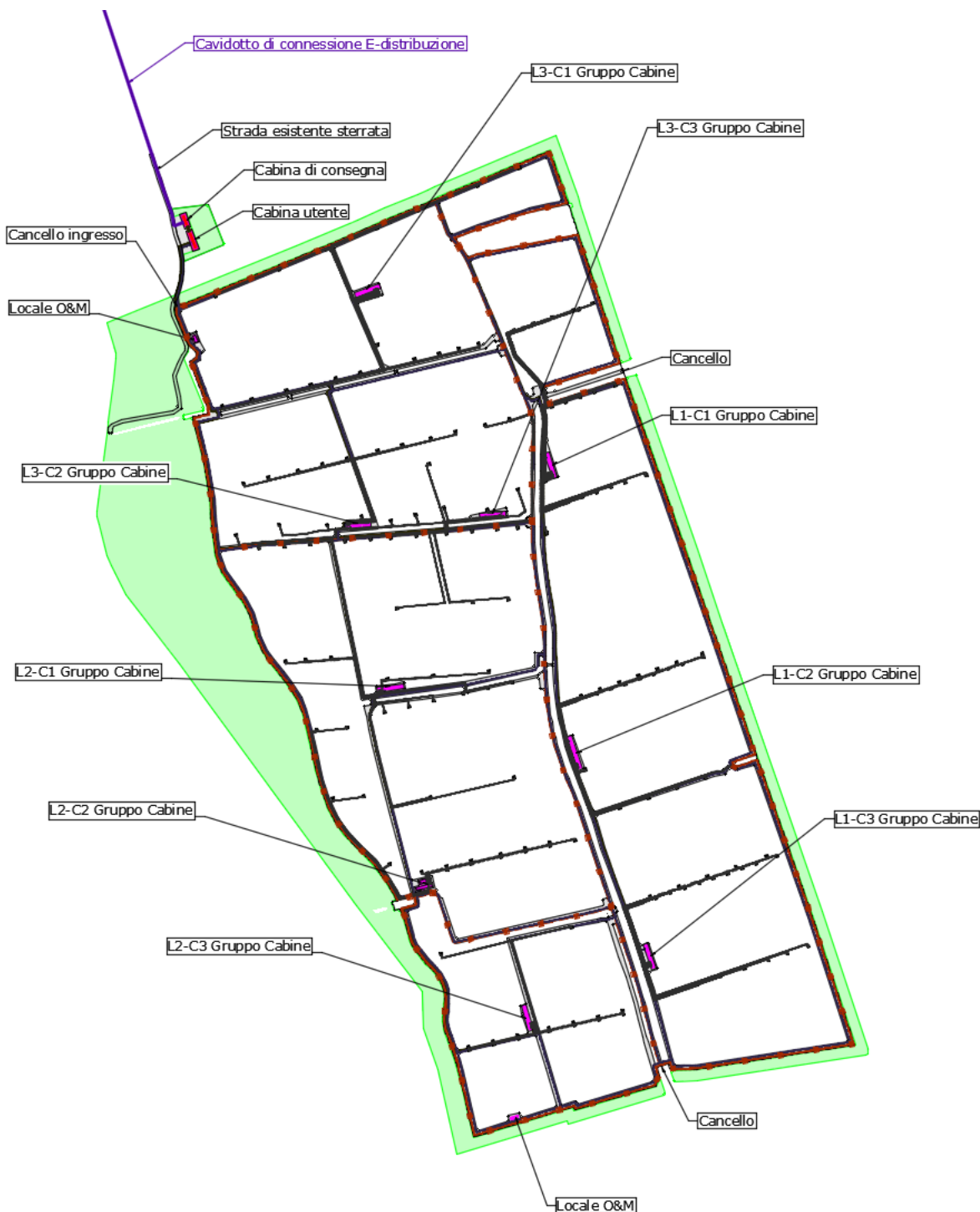
Figura 18 - Layout viabilità cavidotti e cabine
