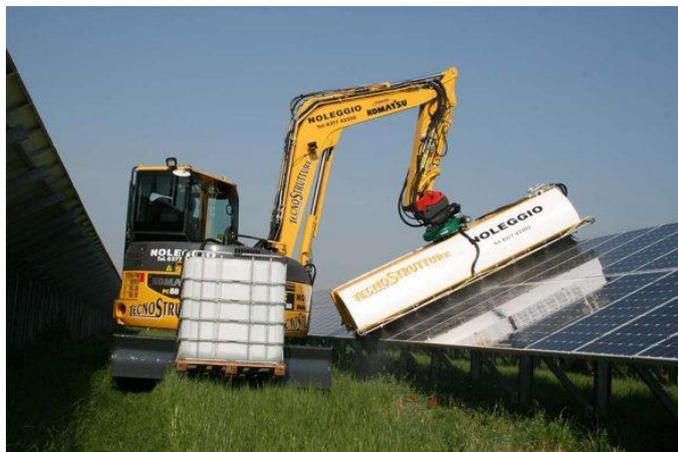
*Esempio di sistema di lavaggio moduli fotovoltaici.*
