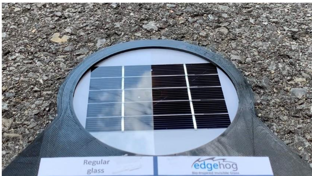
Figura 4: Le due immagini dimostrano in modo lampante come, al contrario di un vetro comune (normal glass), il vetro anti-riflesso (Anti-Reflecting glass) che riveste i moduli fotovoltaici (Photo Voltaic Modules) riduca drasticamente la riflessione dei raggi luminosi
