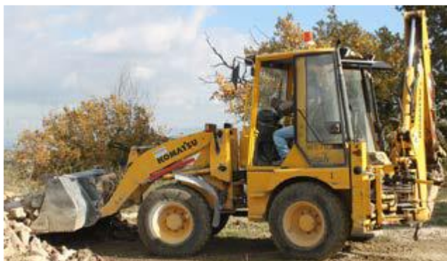
Escavatore caricatore (Terna)
