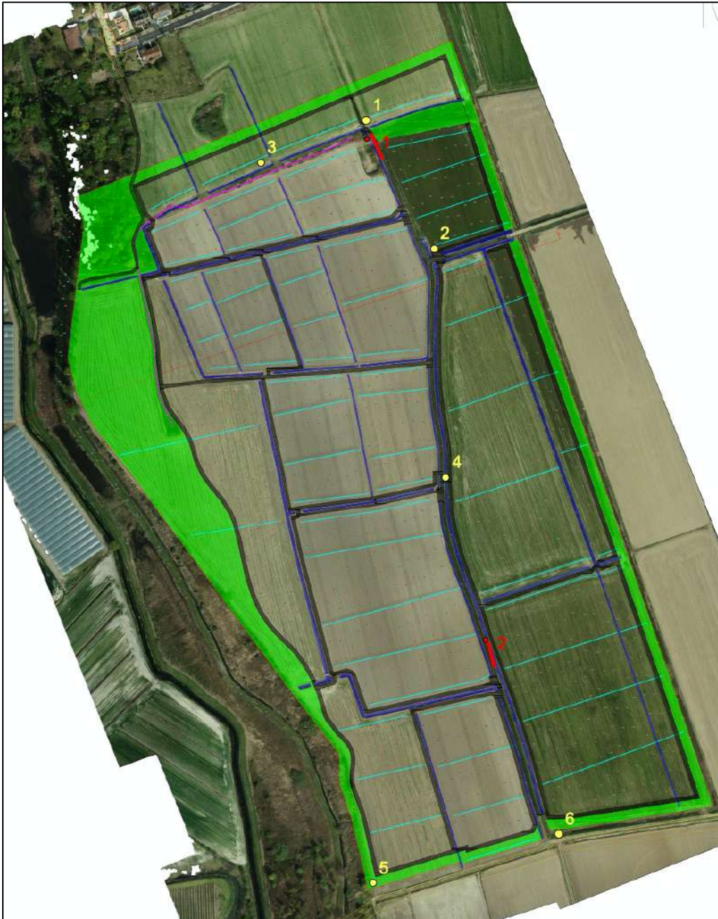
Figura 8 - Localizzazione delle indagini geognostiche su planimetria dello stato di fatto: in giallo, prove penetrometriche statiche CPT; in rosso, basi sismiche MASW e HVSR
