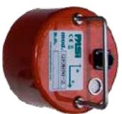
Geofono triassiale Gemini 2 utilizzato per le misure
