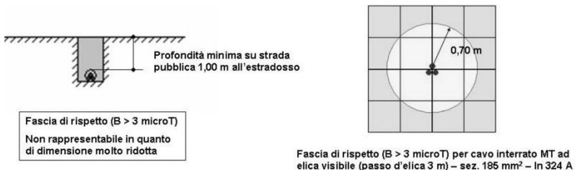
Pertanto, come descritto nel paragrafo 7.1.1 della norma CEI 106-11, per questa tipologia di impianti realizzati con cavi cordati non è necessario stabilire una fascia di rispetto in quanto l'obiettivo qualità è rispettato ovunque.
