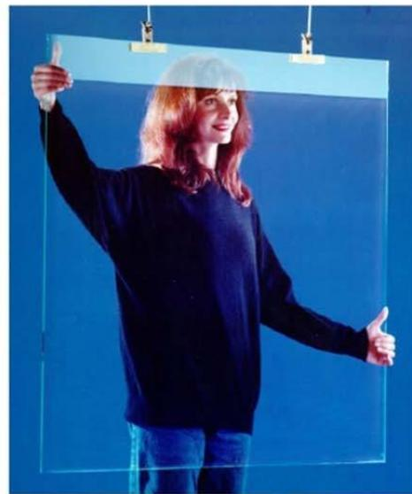
Le due immagini dimostrano in modo lampante come, al contrario di un vetro comune (normal glass), **il vetro anti-riflesso (Anti-Reflecting glass) che riveste i moduli fotovoltaici (Photo Voltaic Modules) riduca drasticamente la riflessione dei raggi luminosi.**
