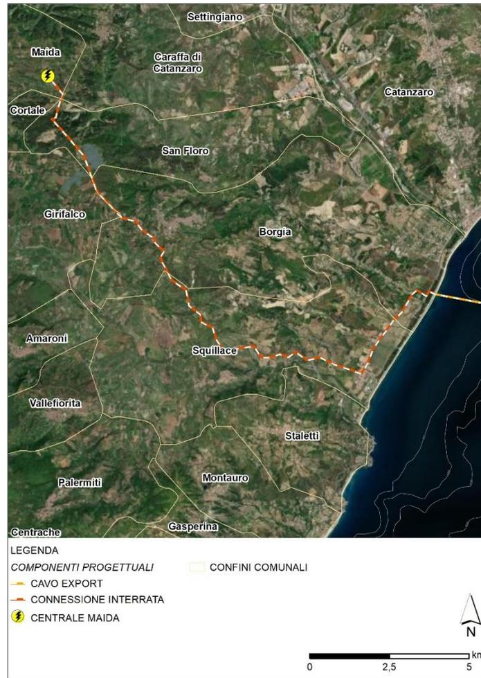
**Figura 55: Percorso dei cavi terrestri verso la sottostazione Maida 380 kV per il progetto Fortevento.**
