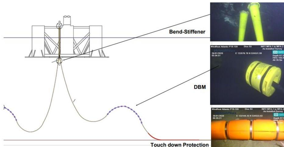
**Figura 38: Esempio di layout di cavo inter-array dinamico.**
