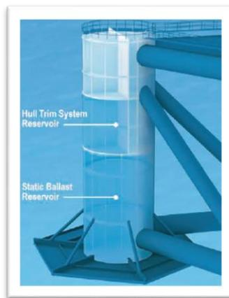
**Figura 28: Sistemi di zavorramento.**
